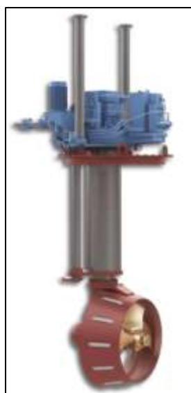
Ilustración 32 Hélice de proa Rolls Royce
