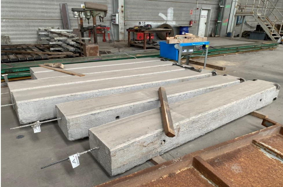
Fig 33: Pilares prefabricados, Fuente: Prefabricados Teide.
