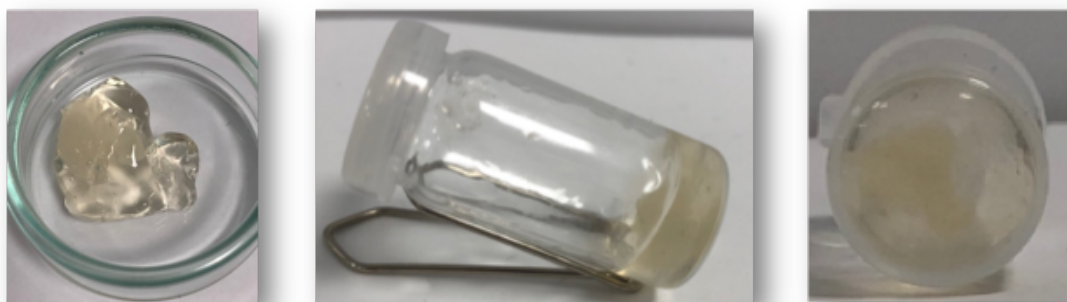
Figura 25. Imágenes correspondientes al sistema híbrido CS-ALG, en el que se produce la precipitación de quitosano por un lado, mientras que el ALG es capaz de formar el hidrogel.
