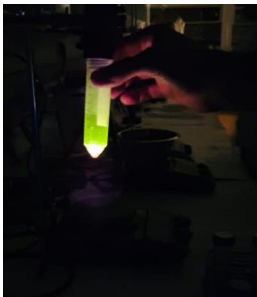
Figura 38. Luminiscencia mediante el mecanismo del UC del NaYF 4 :Yb 3+ /Er 3+ /Gd 3+ .
