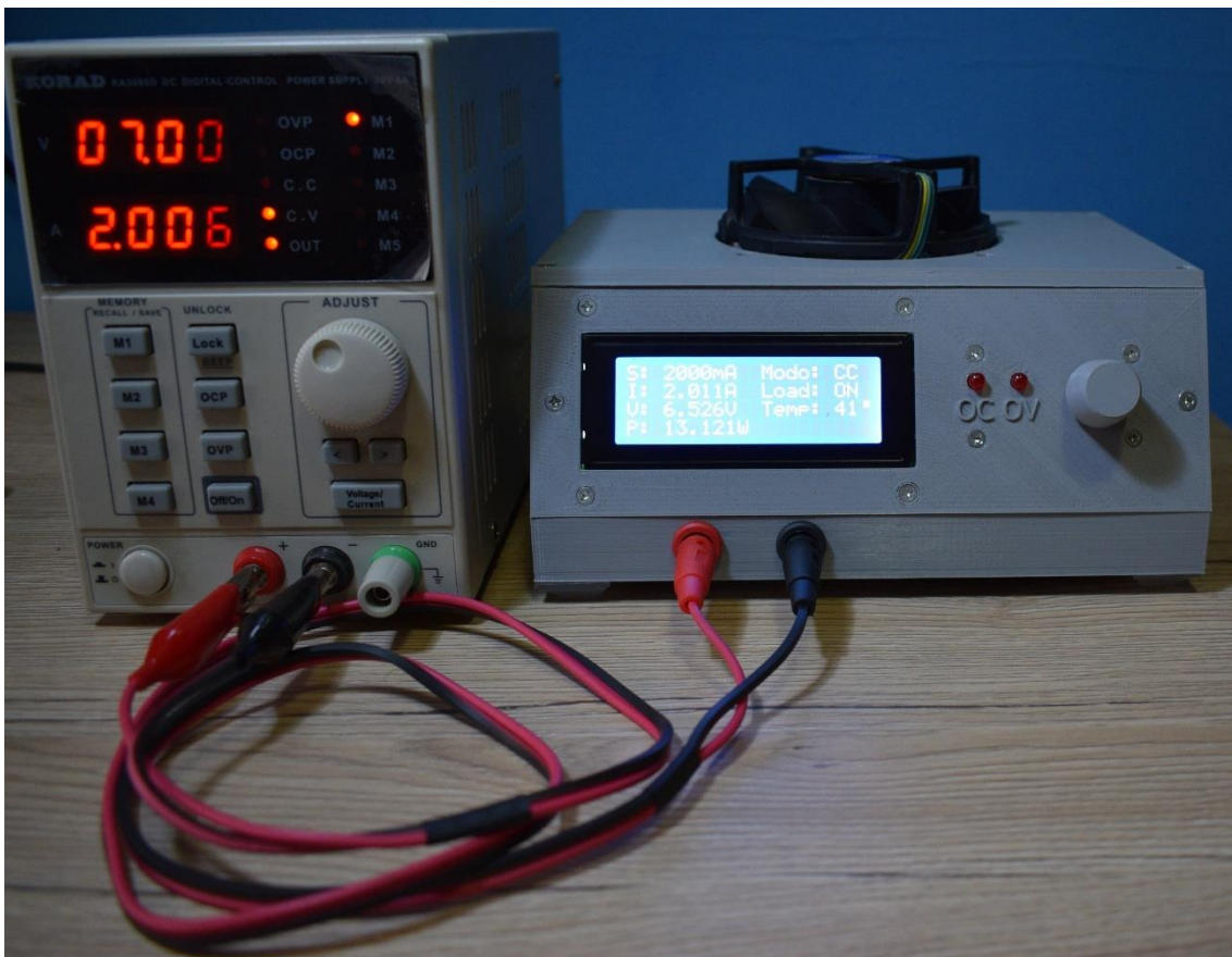
Ilustración 93. Modo CC en funcionamiento. Variación de la tensión de entrada
