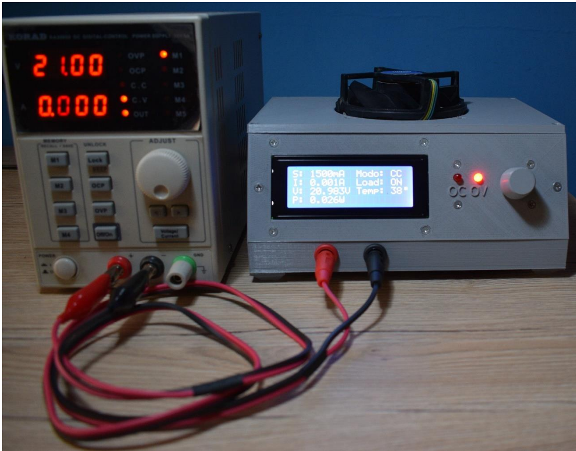
Ilustración 104. Prueba protección sobrecorriente. Resultado
