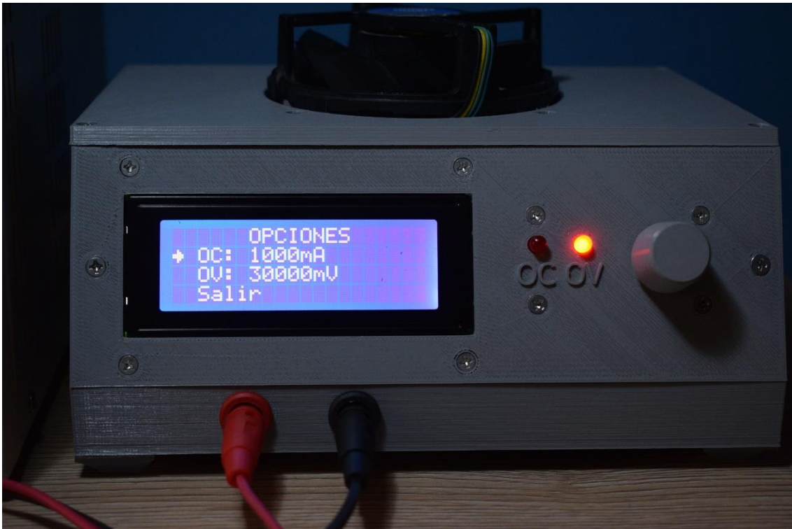
Ilustración 100. Prueba protección sobrecorriente. Ajuste del umbral
