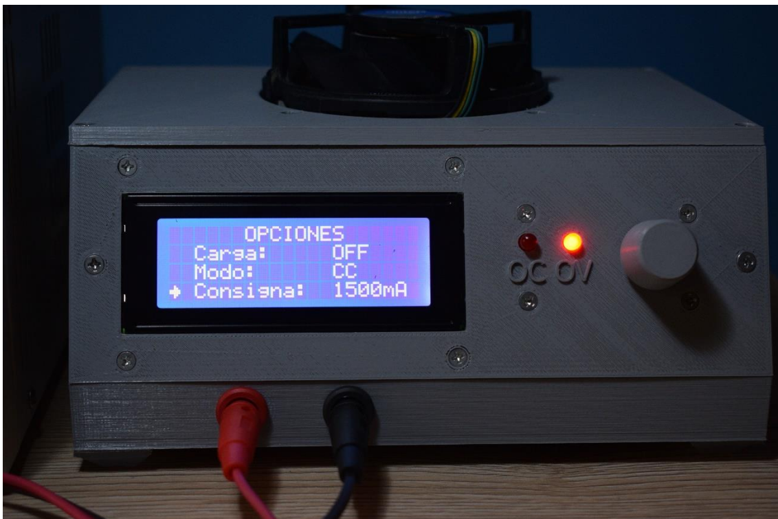
Ilustración 101. Prueba protección sobrecorriente. Consigna 1.5A
