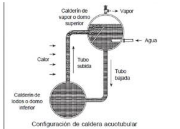
Figura VIII. Funcionamiento caldera acuotubular
