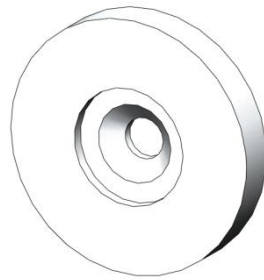
Figura 84: Recubrimiento de la articulación (fuente propia)
