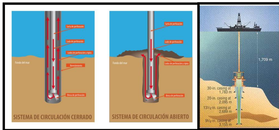
Figura 3. Sistema de circulación abierto y cerrado, y localización del BOP (tomado de: Tesoro & Génova, 2013).
