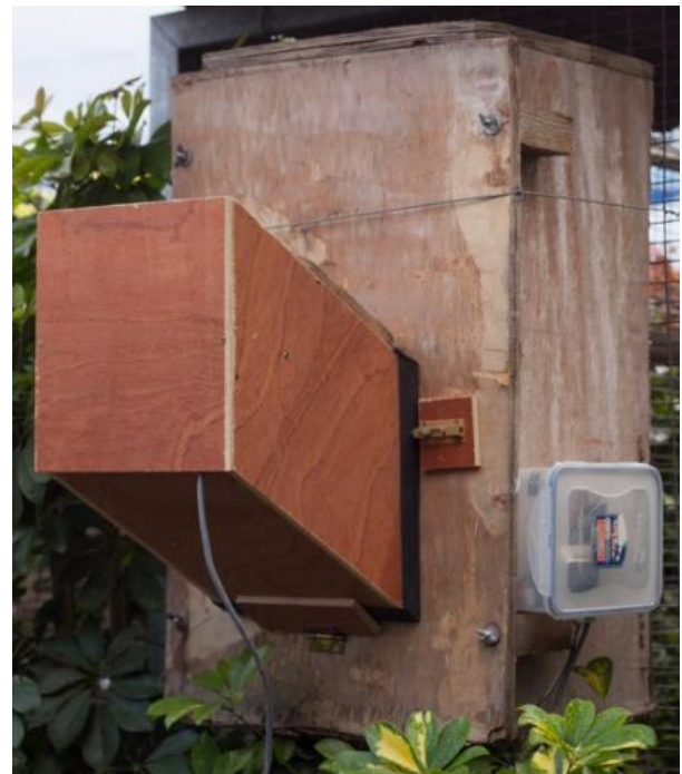
Figura 3. Caja nido donde se puede observar cómo está dispuesto el mecanismo de la cámara en el nido en cuyo interior se encuentra la grabadora con la tarjeta incorporada (caja transparente) y con la ayuda de un cajón se sostiene la lente de la cámara.
