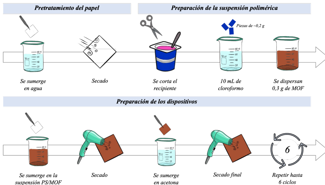
Figura 10. Procedimiento experimental para el pretratamiento del papel, preparación de la suspensión polimérica y los dispositivos de película delgada
