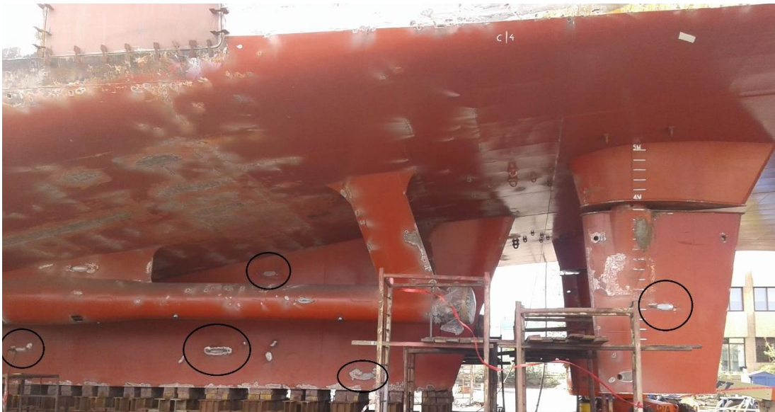
Imagen 12: Distribución de ánodos en zona de codaste y pala de timón, previa su sustitución. B/F “Volcán de Taburiente”. Fuente: Asbel Luis Lorenzo
