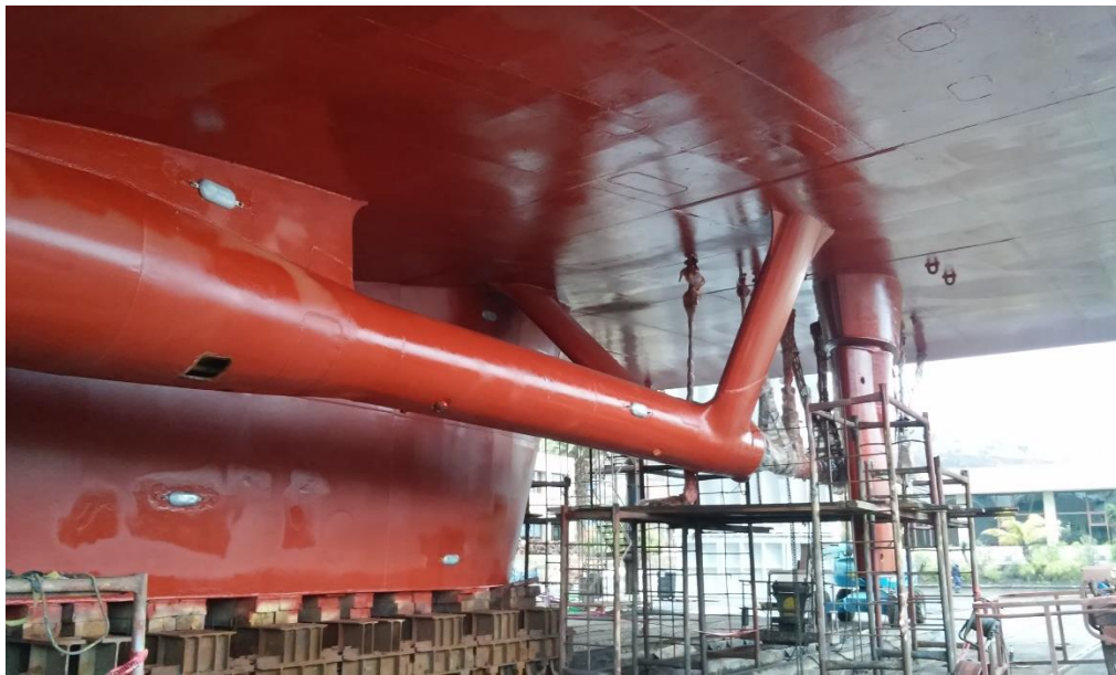
Imagen 7: Ánodos de sacrificio instalados en quilla y bocina del B/F “Volcán de Taburiente”. Fuente propia.
