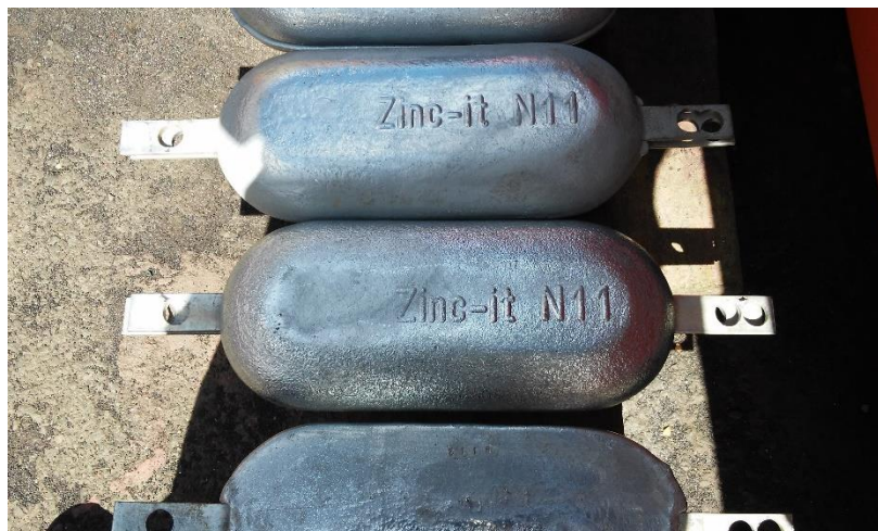
Imagen 5: Ánodos de cinc antes de su fijación en el B/F “Volcán de Taburiente”. Fuente propia.
