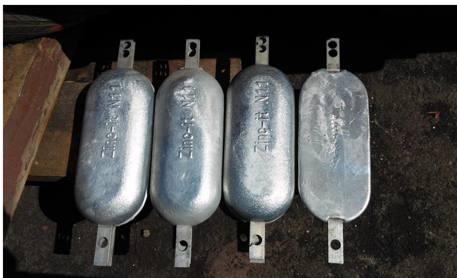
Imagen 9: Ánodos de sacrificio de cinc del B/F “Volcán de Taburiente”. Fuente propia.
