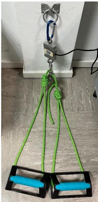
Figura 3.6 Galga extensiométrica y sistema de agarre.
