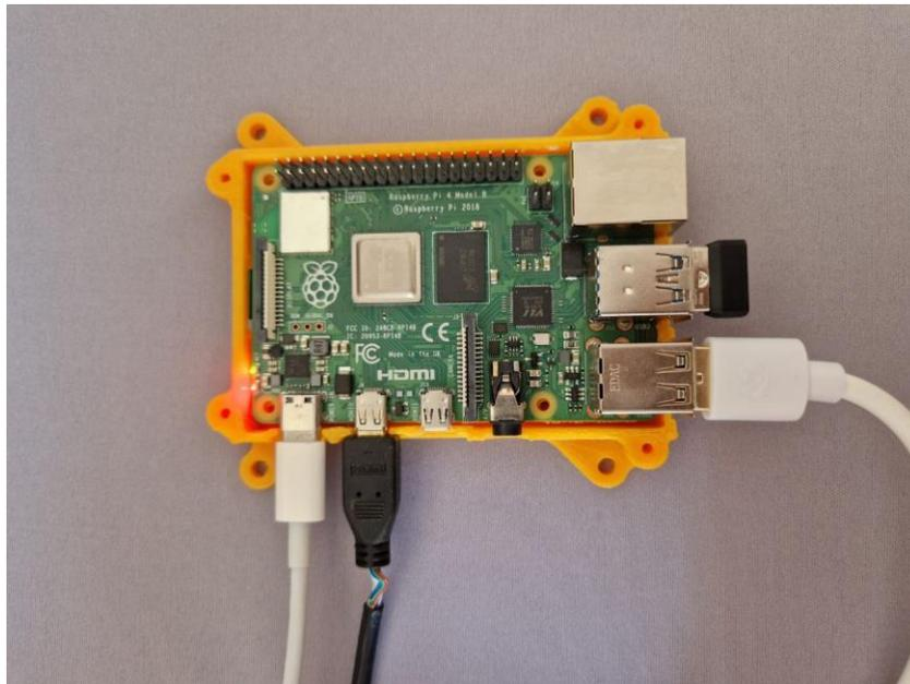
Figura 23: Raspberry Pi 4 utilizada en este TFM.
