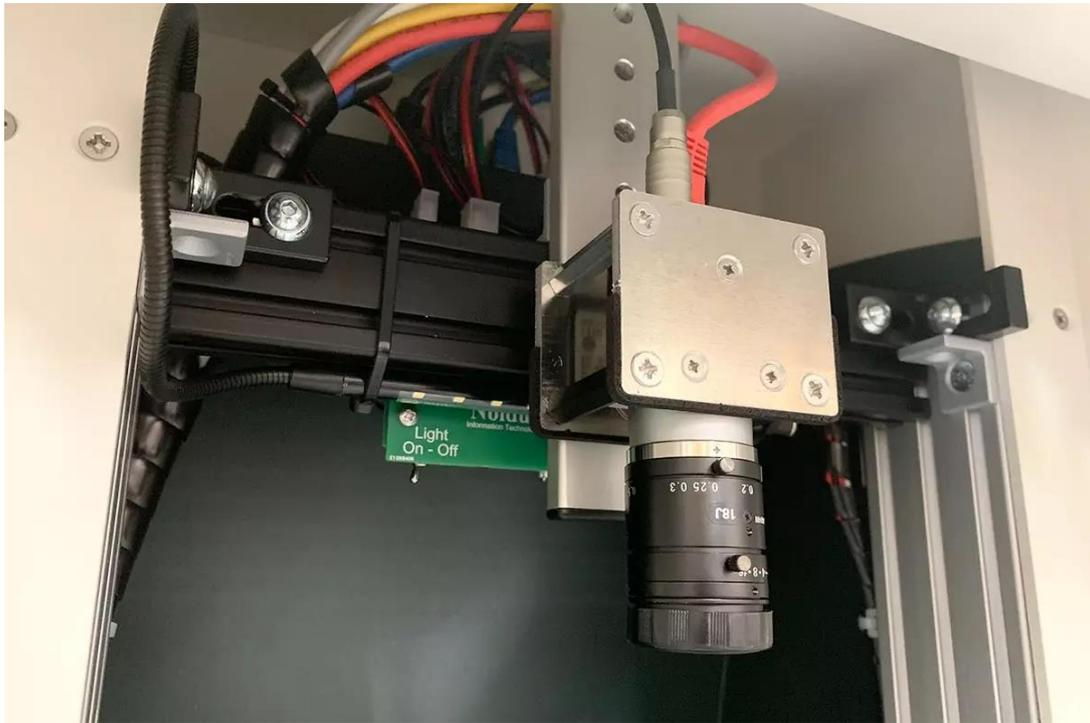
Figura 9: Cámara de observación en el robot DanoVision [8]
