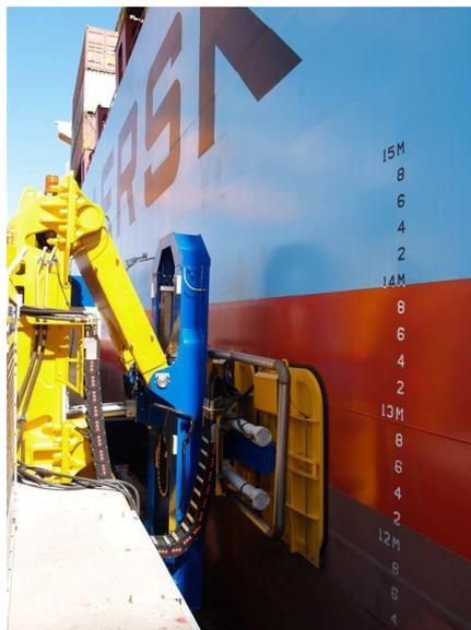
**Ilustración 8.** Sistema de amarre por vacío. Fuente: [www.cavotec.com](http://www.cavotec.com)
