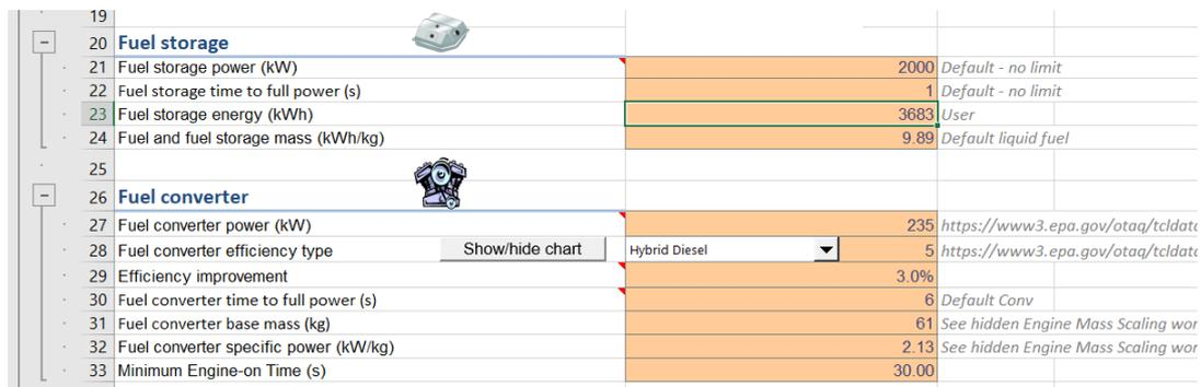
Figura 9.2. Apartados "Fuel storage" y "Fuel converter".
