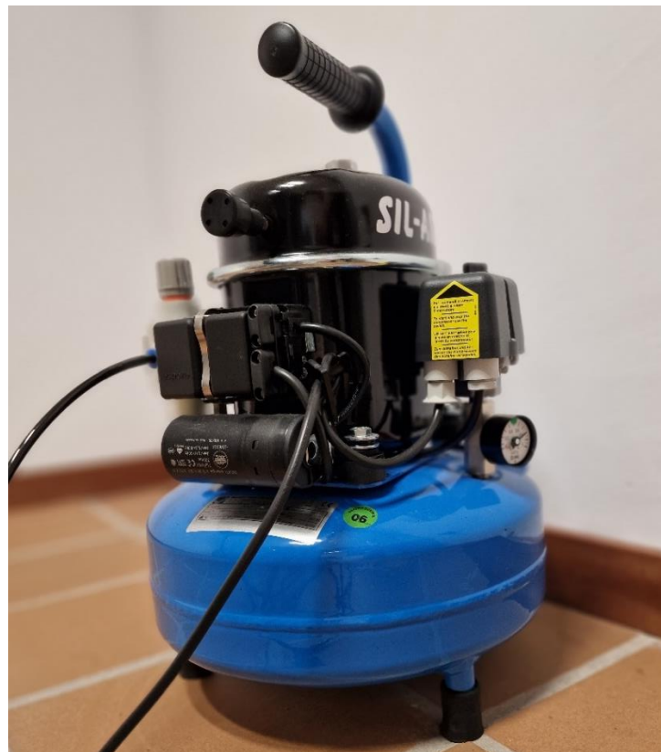
Figura 13: Compresor de aire utilizado para suministrar aire a la planta FAS-200.
