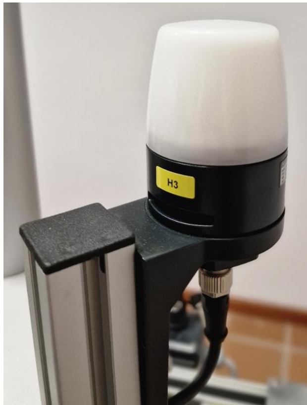
Figura 44: Baliza luminosa y sonora NE-ILNB-M.
