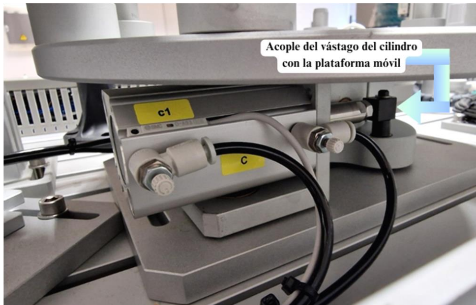
Figura 27: Final de carrera y cilindro de bloqueo de la estación FAS-209.
