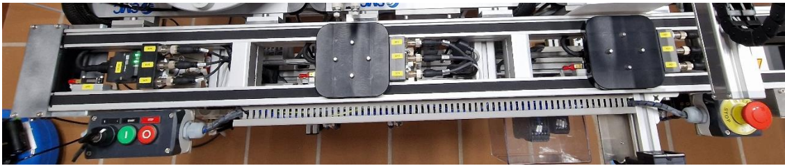
Figura 16: Transfer de planta FAS-200.
