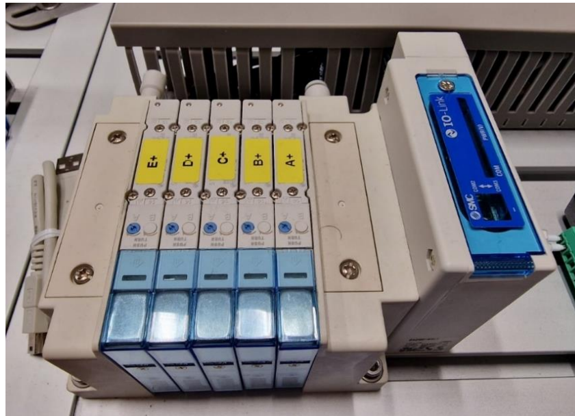
Figura 38: Bloque de electroválvulas de la estación FAS-209.
