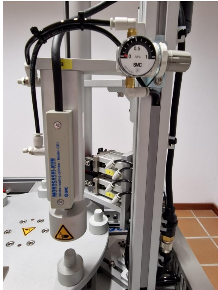
Figura 32: Medidor de alturas de la estación FAS-209.
