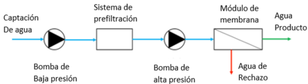
Ilustración 10: Distintas fases de la planta de osmosis inversa del agua marina de 2 etapas.
