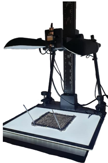
Figura 71. Malla de captación Raschel doble centrada en la plataforma de cristal y alumbrada por el foco inferior a una cierta intensidad. Fuente propia.
