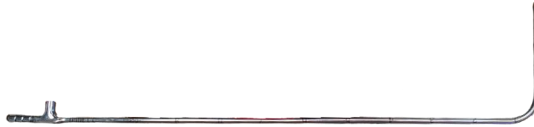
Figura 69. Tubo de Pitot que va conectado en el manómetro diferencial para la toma de velocidades y caudales. Fuente propia.
