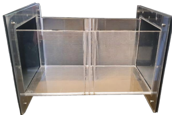
Figura 57. Cámara de ensayos, donde se puede apreciar que la cara superior está abierta (40 cm x 20 cm x 20 cm). Fuente propia.
