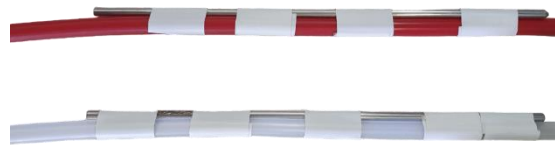
Figura 66. Tubos del manómetro diferencial rigidizados con una varilla de metal unida con cinta aislante. El tubo rojo corresponde a la toma positiva colocada a la entrada de la malla y el tubo blanco a la toma negativa colocada en la salida de la malla. Fuente propia
