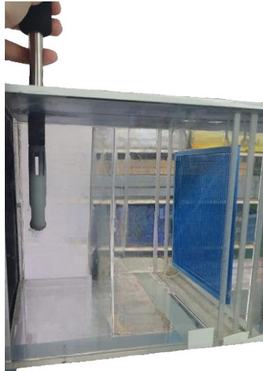
Figura 68. Método de medición de la velocidad del flujo libre, donde se inserta el anemómetro de hilo caliente al principio de la cámara de ensayos y suficientemente alejado de la malla de captación. Fuente propia.
