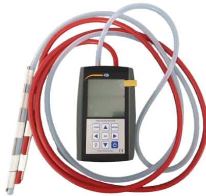
Figura 64. Manómetro de presión diferencial (PCE-PDA 1L). El borne de la derecha es la toma positiva (manguera roja) y el de la izquierda es la toma negativa (manguera blanca). Fuente propia.
