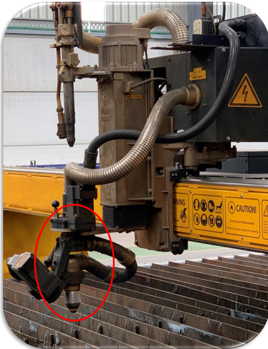
Ilustración n°10: Antorcha de arcoplasma Fuente: Trabajo de campo
