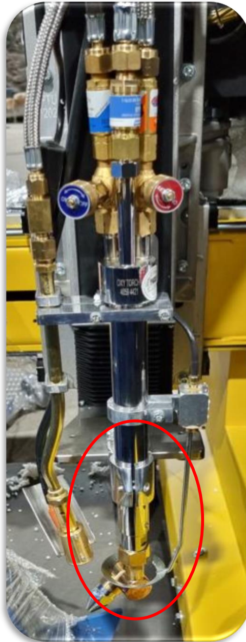
Ilustración n°11: Boquilla de corte oxiacetilénico Fuente: Trabajo de campo
