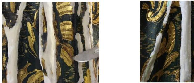
**Fig. 4-66.** Nivelado del estuco con bisturí (Izq.), finalizado del nivelado (Dcha)
