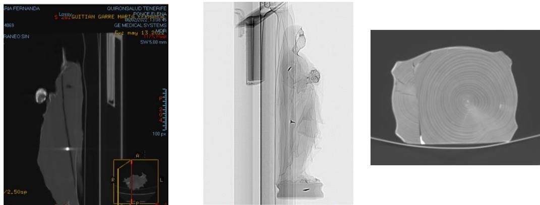
**Fig. 4-39.** Tomografía lateral, muestra una separación en la línea de unión de los bloques (Izq.), se muestran 3 clavos de forja a modo de refuerzo (centro) y hay una grieta en la base por la línea de unión y otras más pequeñas causa del envejecimiento de la madera (Dcha.)
