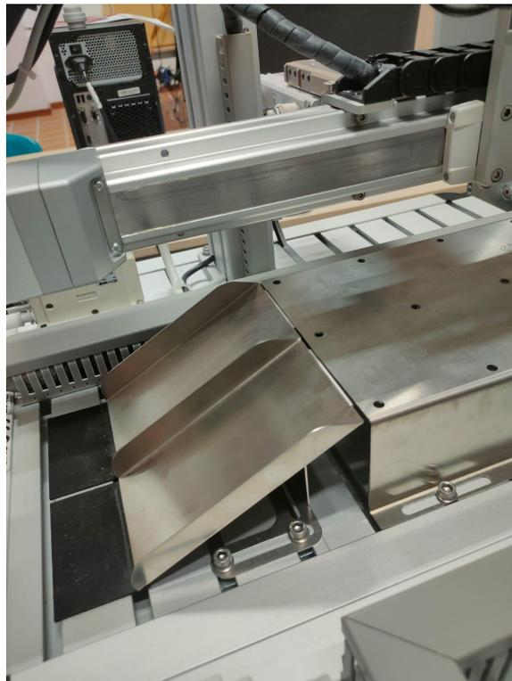
*Figura 27: Rampas de salida*
