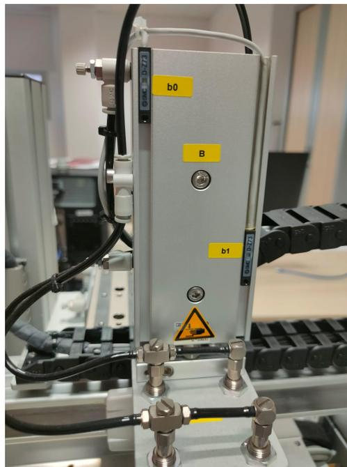
*Figura 33: Sensores de final de carrera del eje vertical*
