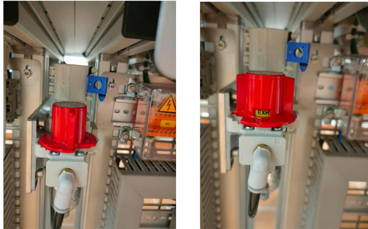
Figura 12: Válvula de aire abierta y cerrada
