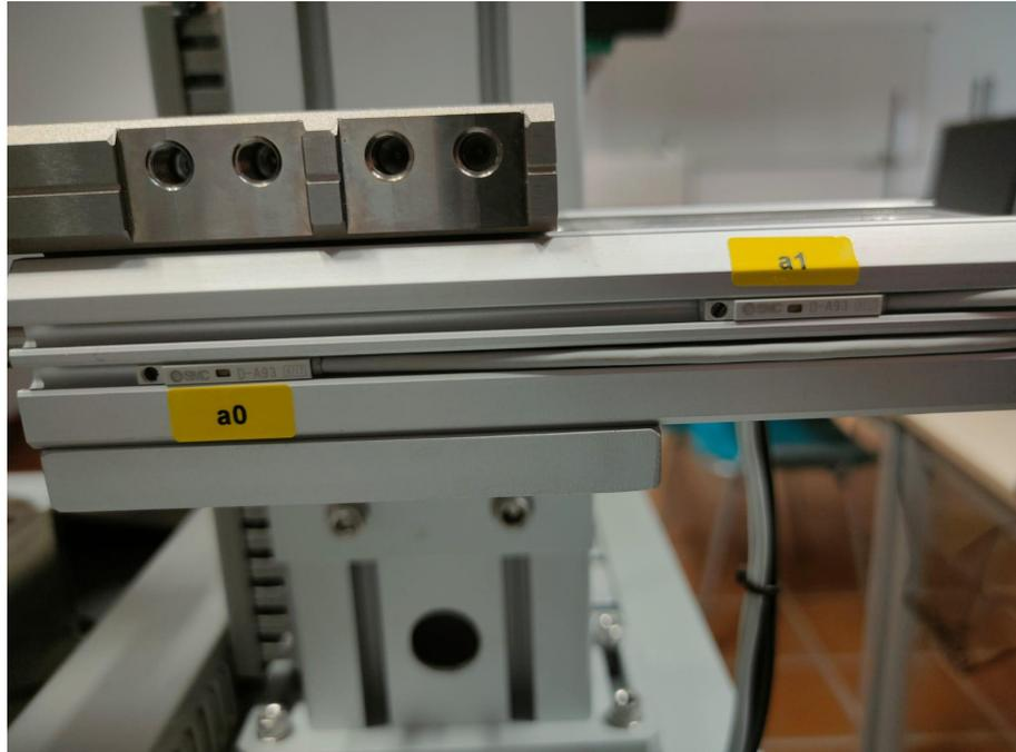
*Figura 32 : Sensores de final de carrera del eje horizontal*
