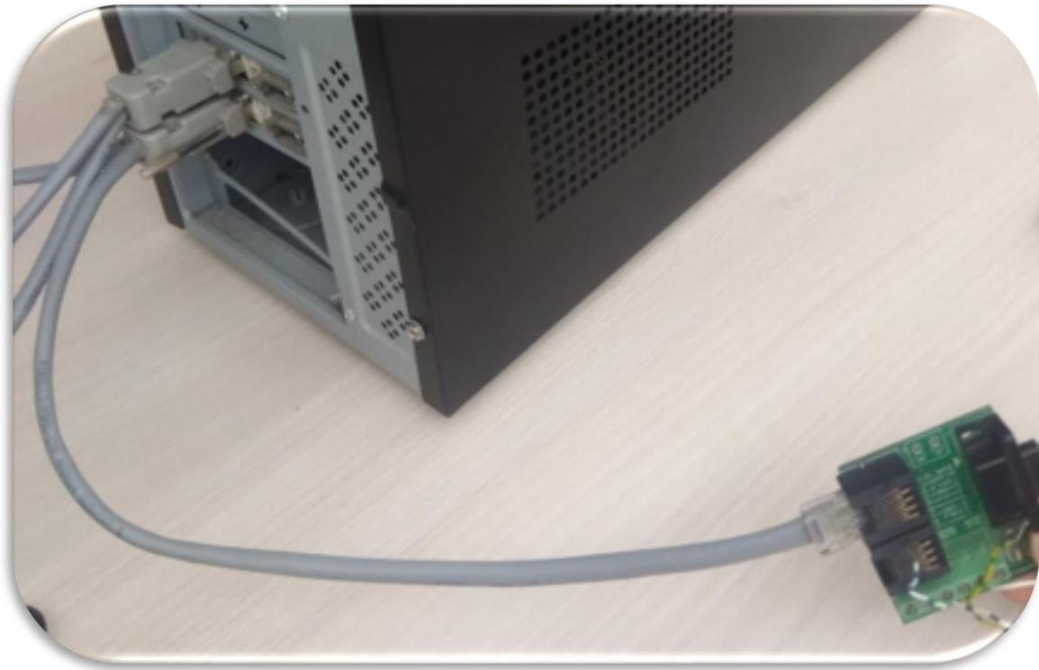
Figura 2.18 Conexión física PC-BBB con RJ-45
