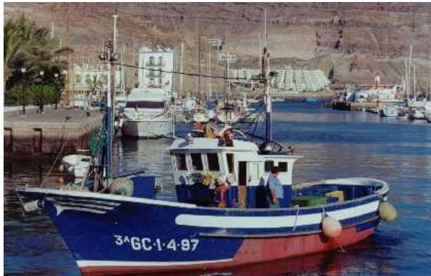
Figura 3. Buque Katimade. Eslora total 13,85 m, Potencia 22,06 kW (30,0 CV)
