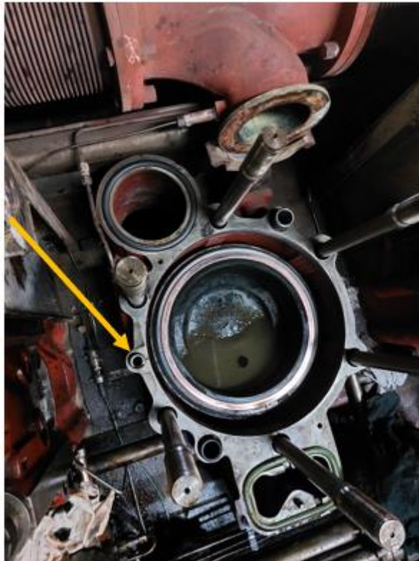
Ilustración 192. Conducto de entrada del aire de arranque. Elaboración propia.
