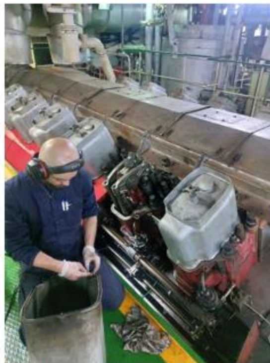
Ilustración 221. Sustitución de juntas de las tapas del motor. Elaboración propia.
