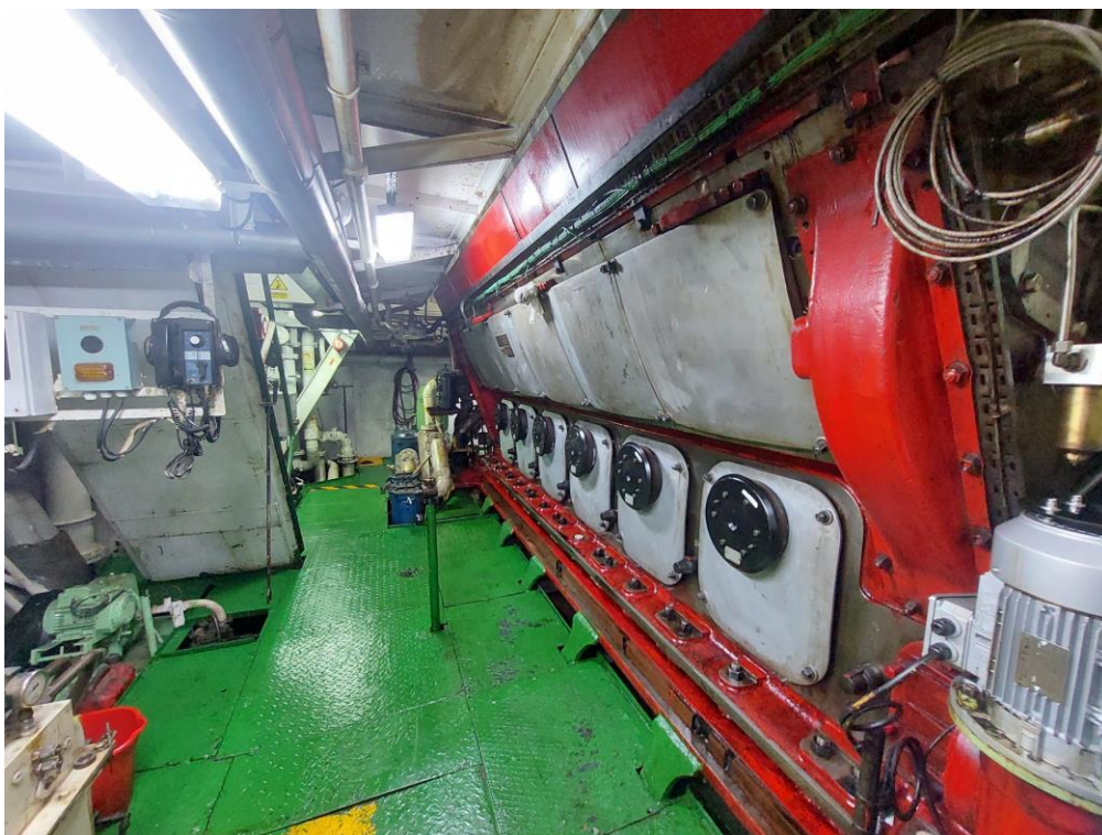
Ilustración 40. Bloque del motor principal. Elaboración propia.
