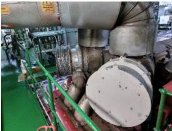
Ilustración 201. Limpieza filtros de aspiración de los turbosoplantes. Elaboración propia.
