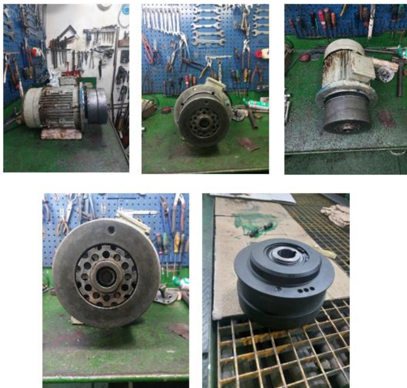
Ilustración 211. Embrague motor de la depuradora. Elaboración propia.
