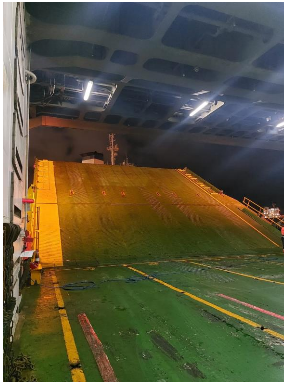
Ilustración 52. Rampa de popa. Elaboración propia.
