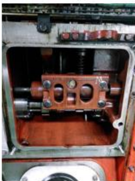
Ilustración 218. Tapas de balancines, eje de camones y cigüeñal. Elaboración propia.
