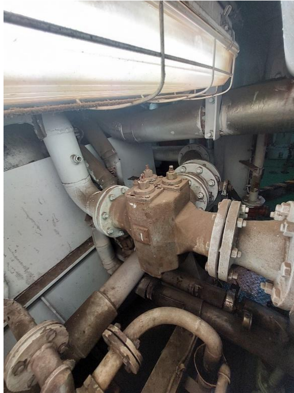
Ilustración 157. Termostática a la salida del motor. Elaboración propia.
