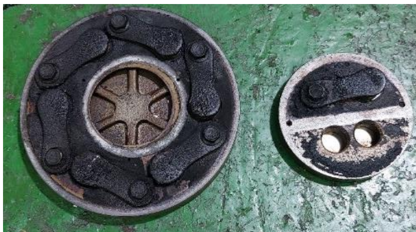
Ilustración 203. Etapas de baja y alta presión sustituidas. Elaboración propia.
