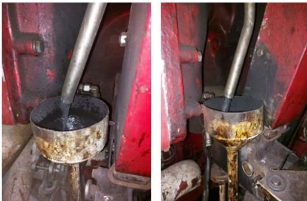
Ilustración 213. Lavado de turbo, lado de gases. Elaboración propia.
