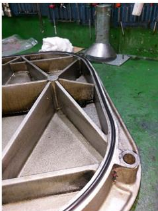
Ilustración 221. Sustitución de juntas de las tapas del motor. Elaboración propia.
