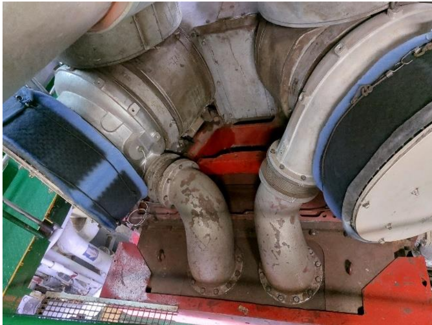
Ilustración 189. Transferencia del aire desde las turbos hacia el enfriador. Elaboración propia.
