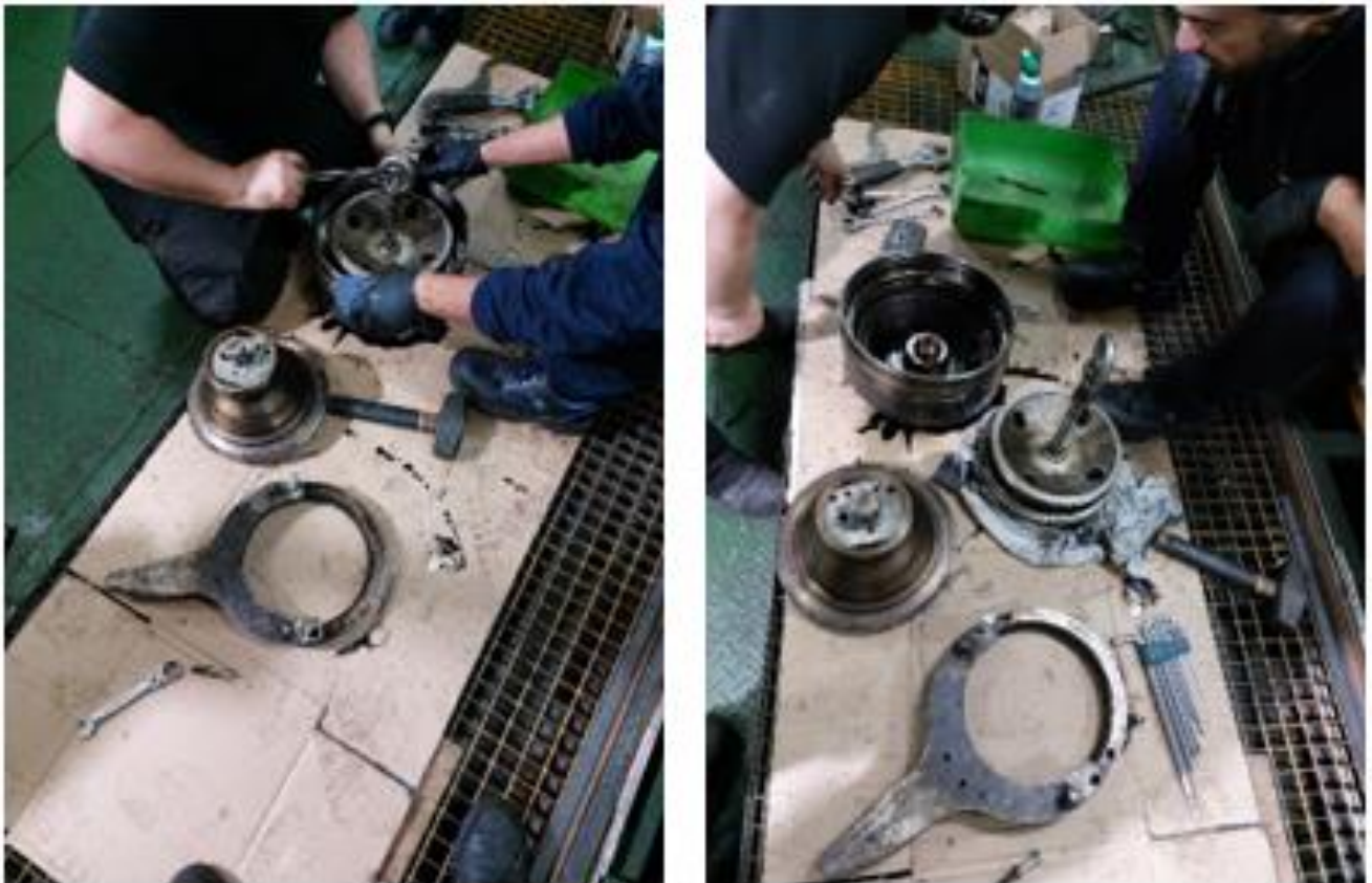
Ilustración 208. Desmontaje de depuradoras. Elaboración propia.
