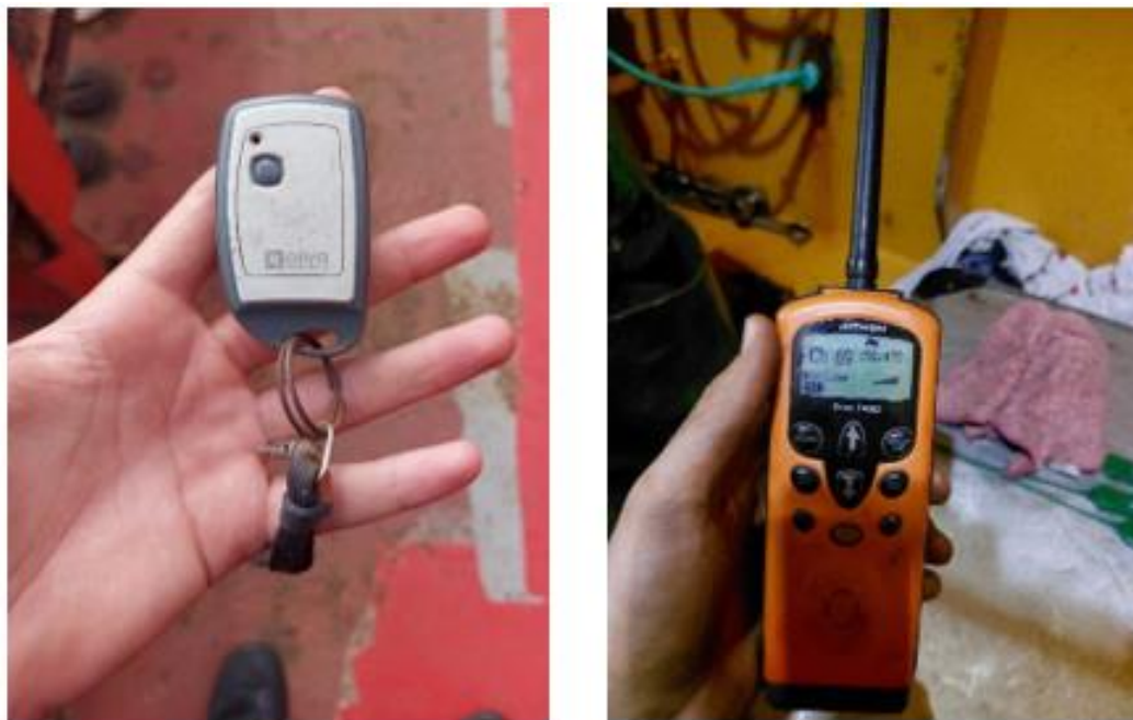
Ilustración 93. Paradas de la bomba de consumo. Control remoto / VHF. Elaboración propia.
