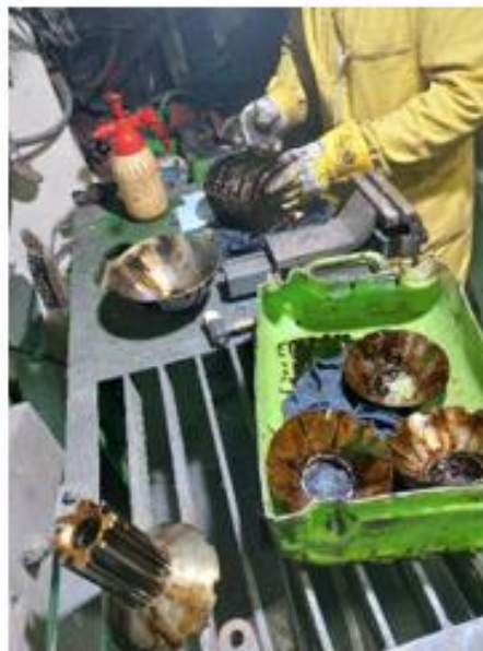
Ilustración 209. Limpieza elementos del bolo, parte 1. Elaboración propia.
