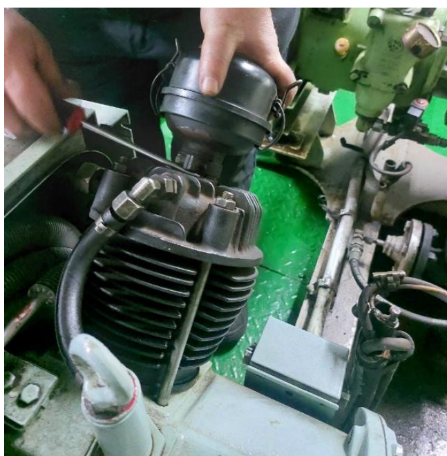
Ilustración 202. Filtro de aire de la etapa de baja presión. Elaboración propia.
