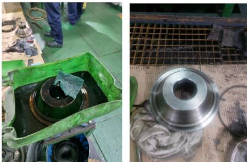
Ilustración 210. Limpieza elementos del bolo, parte 2. Elaboración propia.
