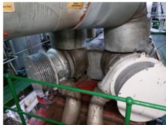
Ilustración 201. Limpieza filtros de aspiración de los turbosoplantes. Elaboración propia.
