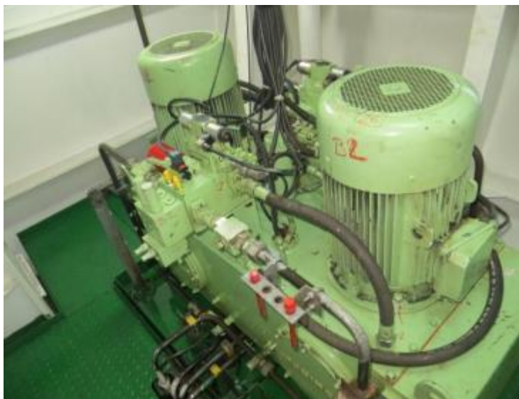
Ilustración 56. Grupo hidráulico del servomotor. Elaboración propia.
