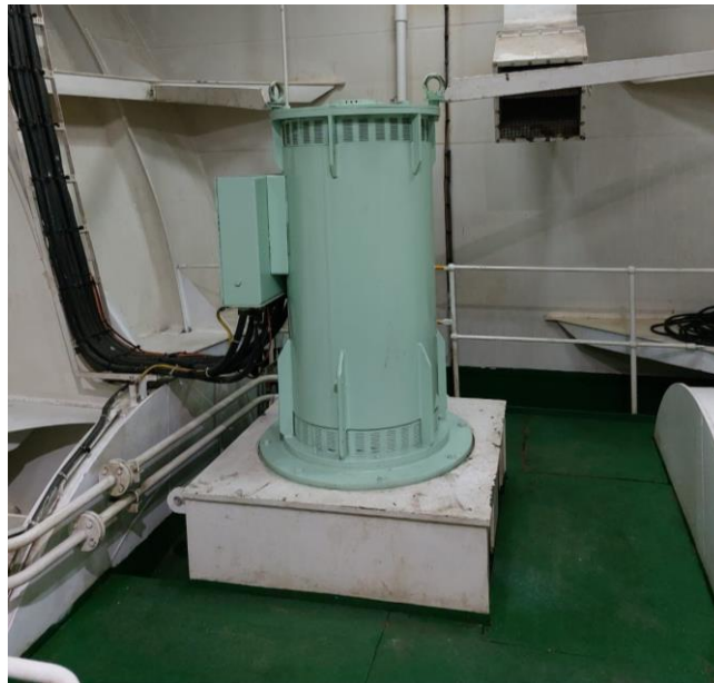
Ilustración 58. Hélice transversal de proa. Elaboración propia.
