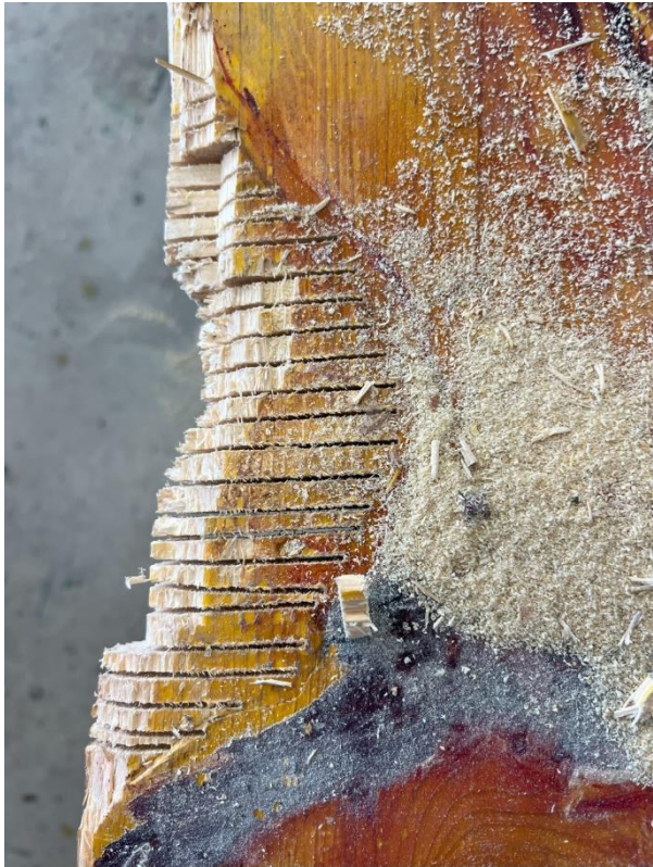
Fig. 74. Líneas paralelas para golpear con el martillo.
