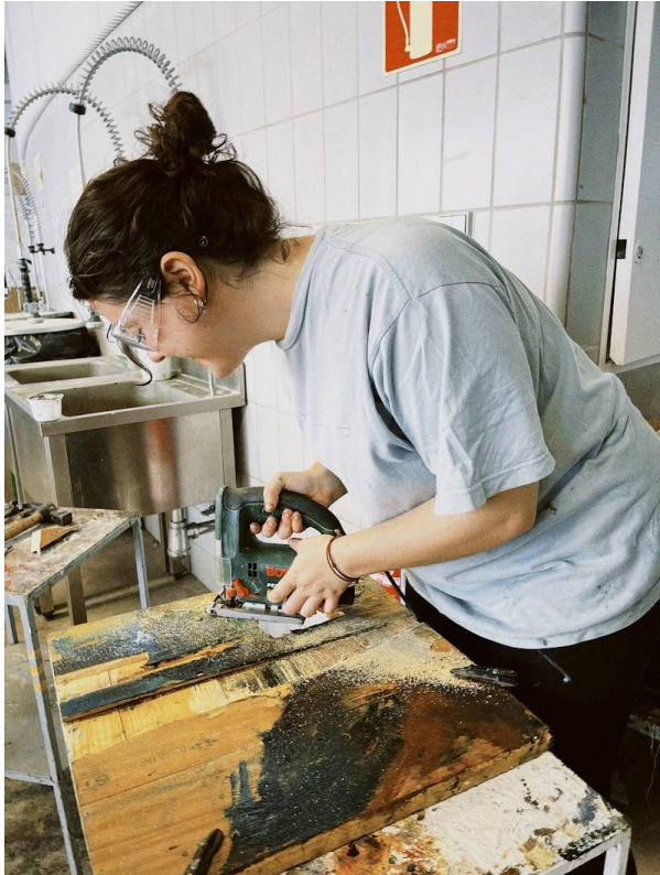
Fig. 83. Realizando un agujero con la caladora.
