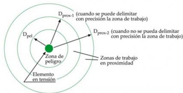
Figura 6.6. Zona de proximidad de riesgo eléctrico.
