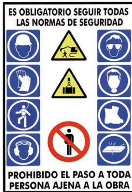
Figura 6.1. Cartel en entrada de obra
