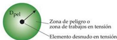
Figura 6.5. Zona de peligro.
