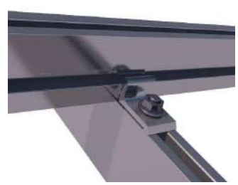
Detalle fijación G1 a triángulo (Son necesarios 2 fijaciones por perfil, 1 por cada lado)
