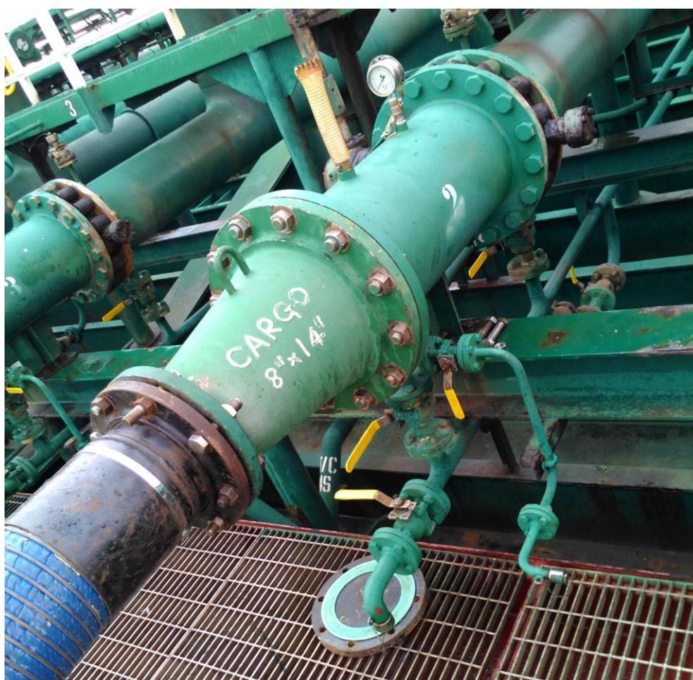
Ilustración 32: Manifold durante la operativa. Fuente: Trabajo de campo
