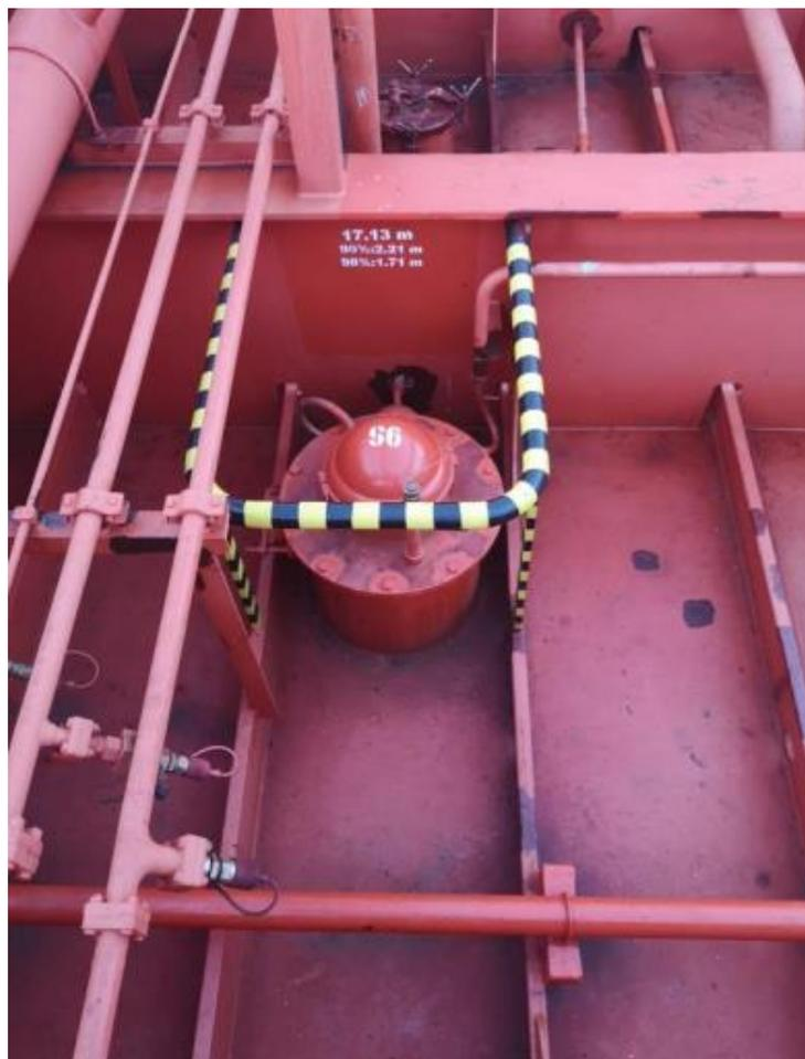
*Ilustración 19: Conexión sonda-radar. Fuente: buque Loukkas I*
