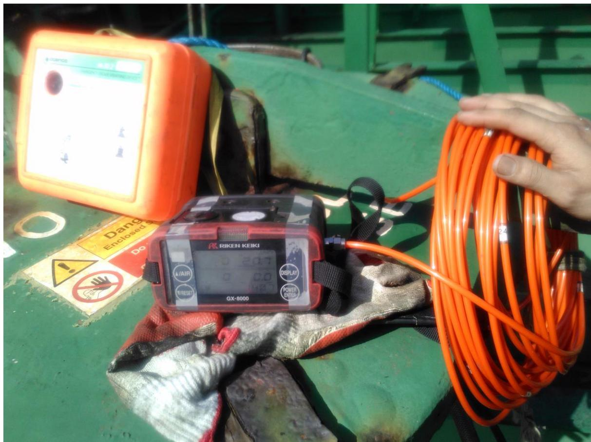
Ilustración 43: Detector de gases nocivos. Fuente: Trabajo de campo.
