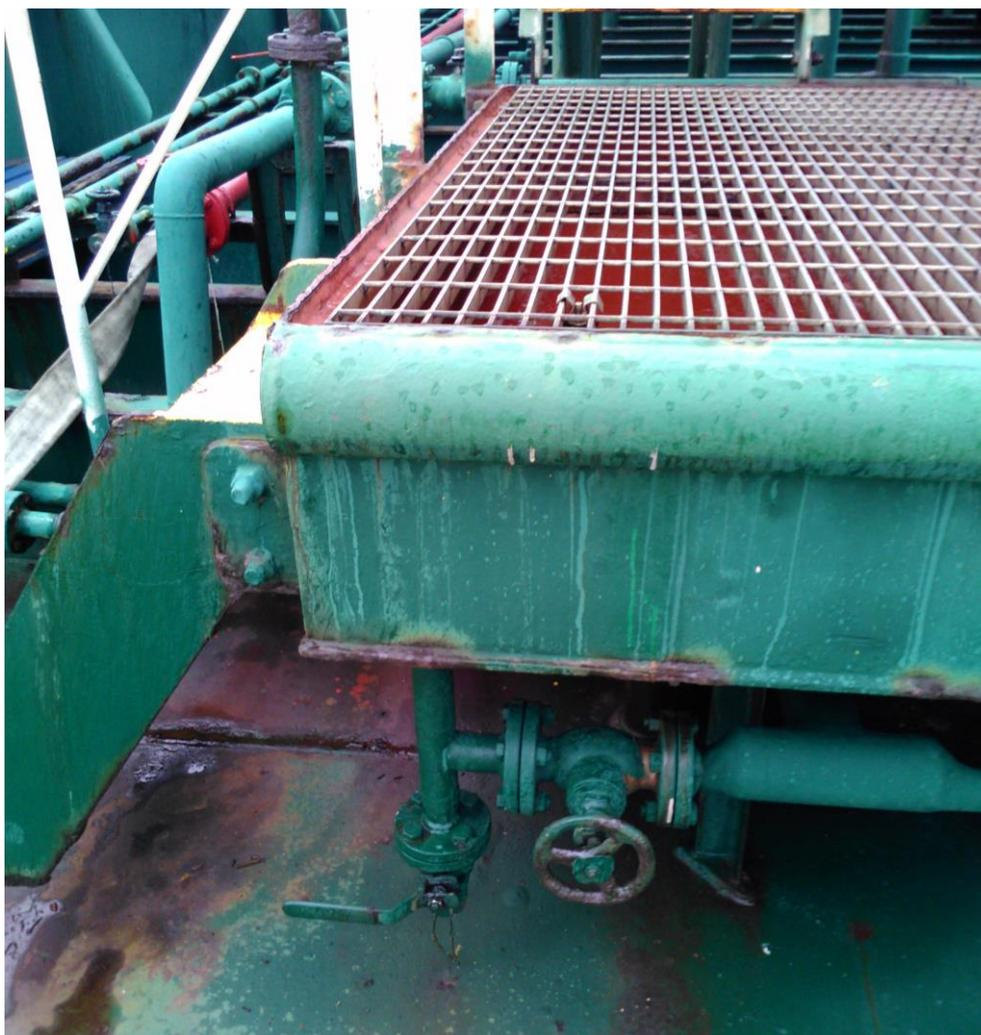
Ilustración 46: Válvula de parado en emergencia. Fuente: Trabajo de campo.
