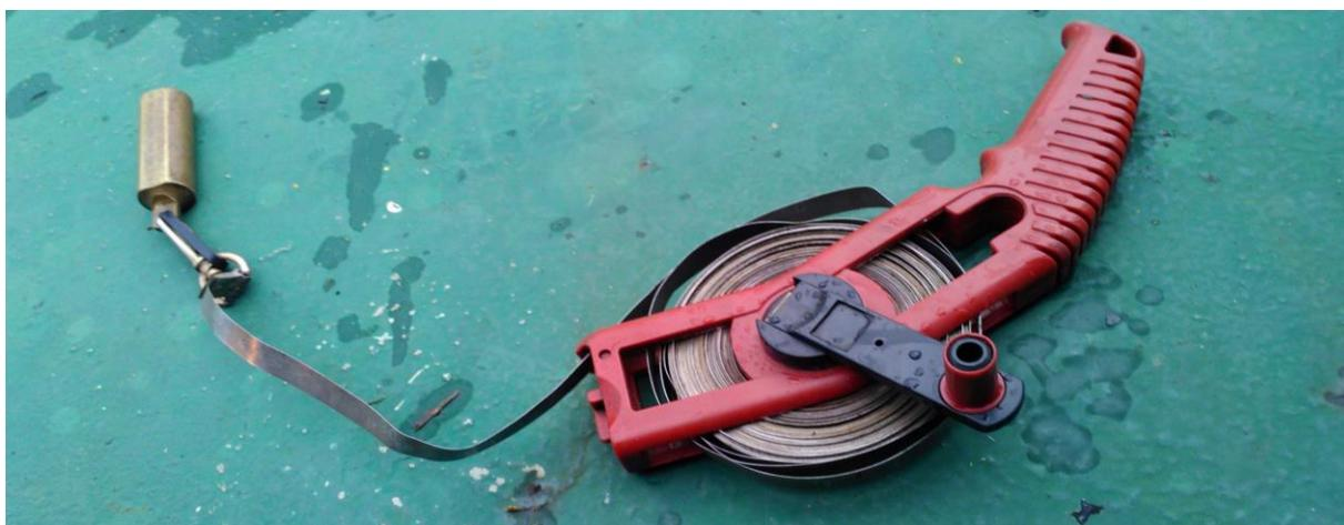
*Ilustración 37: Sonda del tanque de lastre. Fuente: Trabajo de campo*
