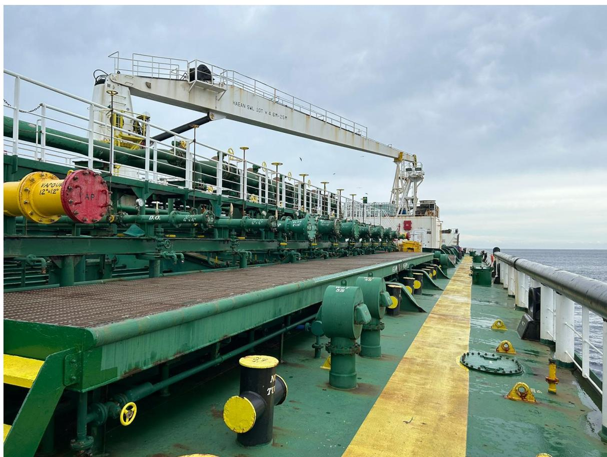
Ilustración 4: Área de manifolds. Fuente: Trabajo de campo.
