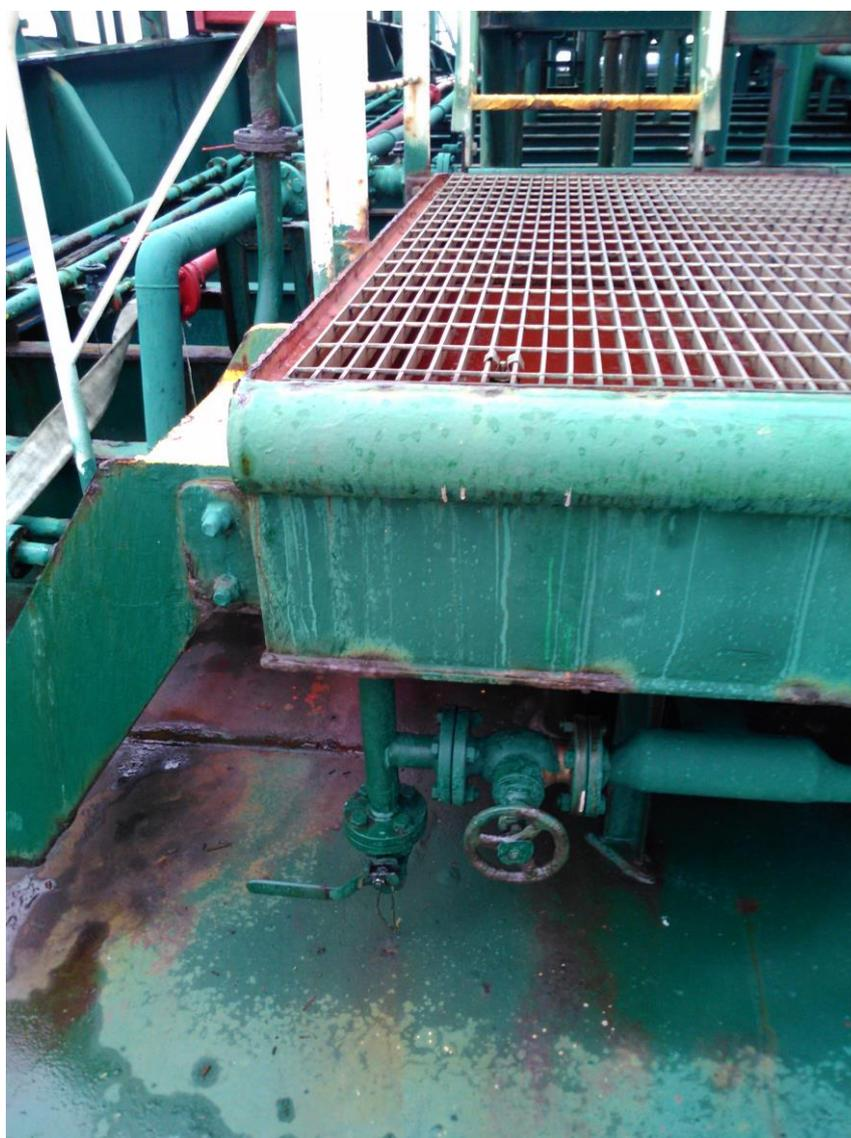
*Ilustración 13: Bandeja del manifold. Fuente: Trabajo de campo*
