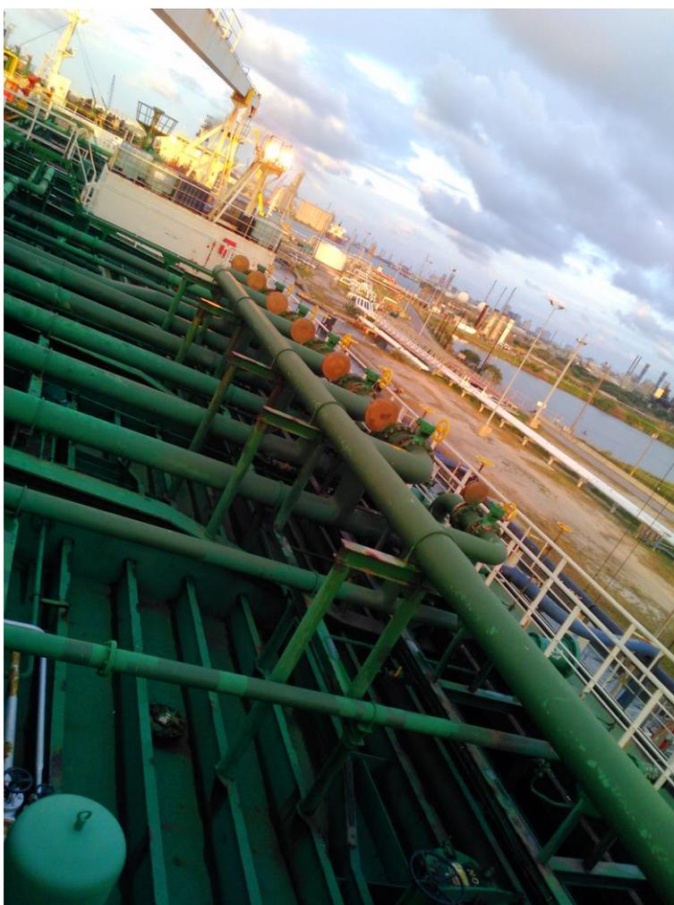
*Ilustración 16: Sistema de crossover. Fuente: Trabajo de campo*
