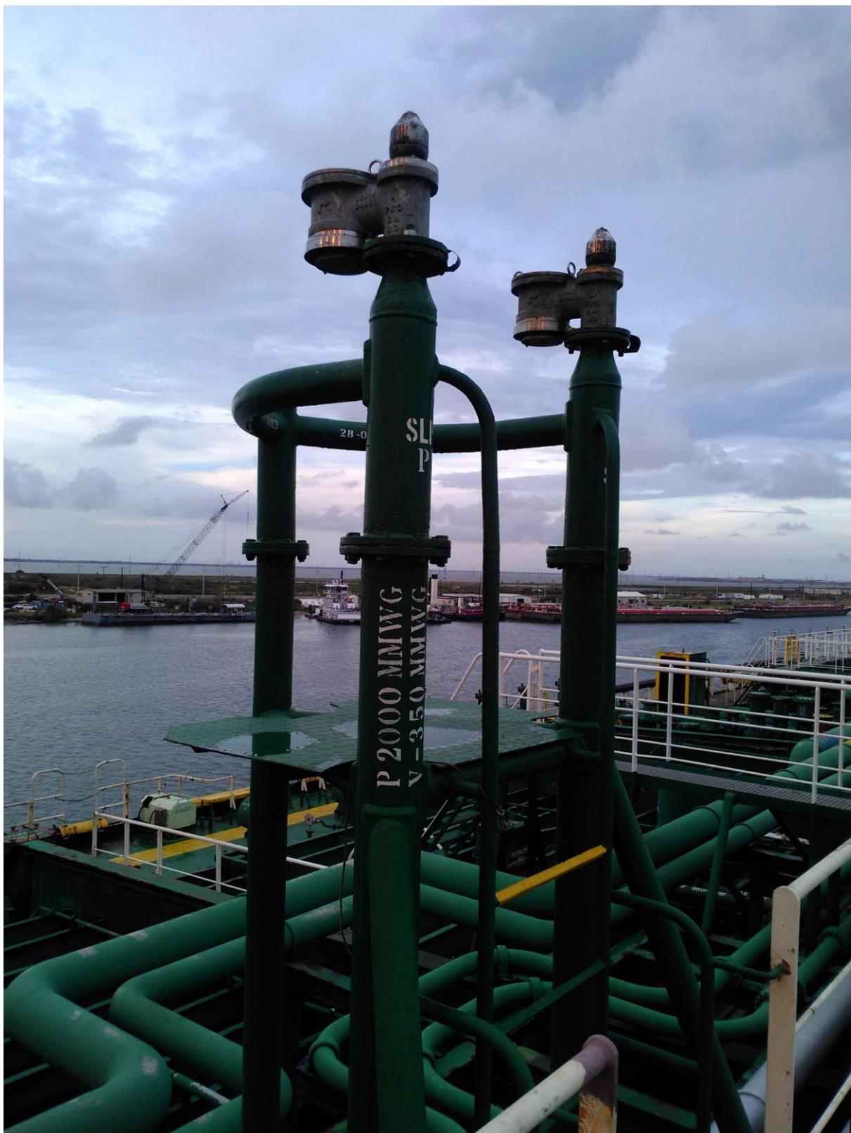
Ilustración 33: P/V Valve. Fuente: Trabajo de campo.
