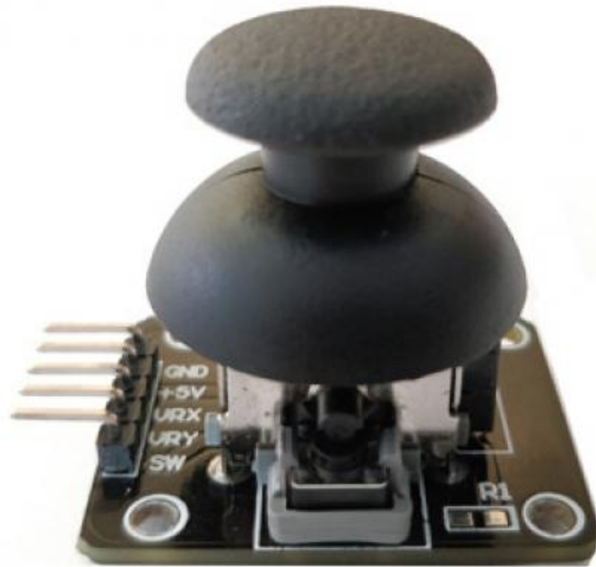
Figura 5.5: Módulo de joystick empleado en el proyecto, se pueden apreciar en su lado izquierdo los pines que vamos a emplear.
