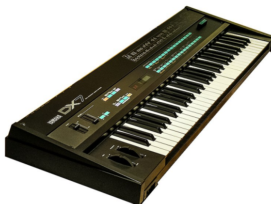
Figura 1.3: Yamaha DX7 el primer sintetizador totalmente digital con un sistema de síntesis de frecuencia.
