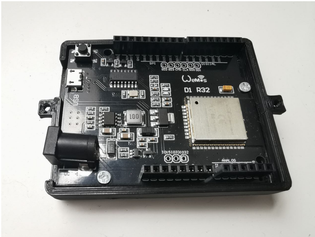
Figura 7.6: Fotografía de la placa Wemos D1 R32 en la parte inferior de la carcasa con dos de sus punto de anclaje atornillados.
