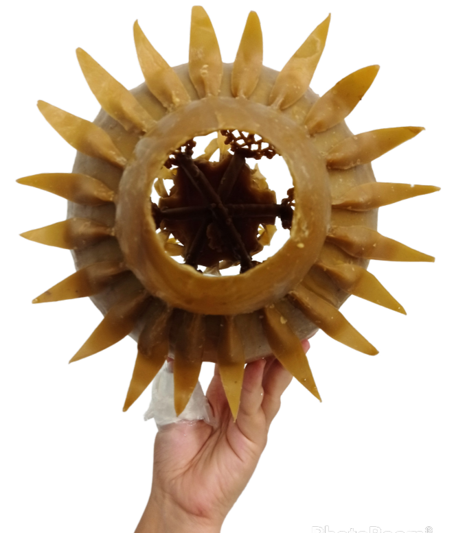
Fig. 29 Pieza en cera perdida, de Colada directa.
