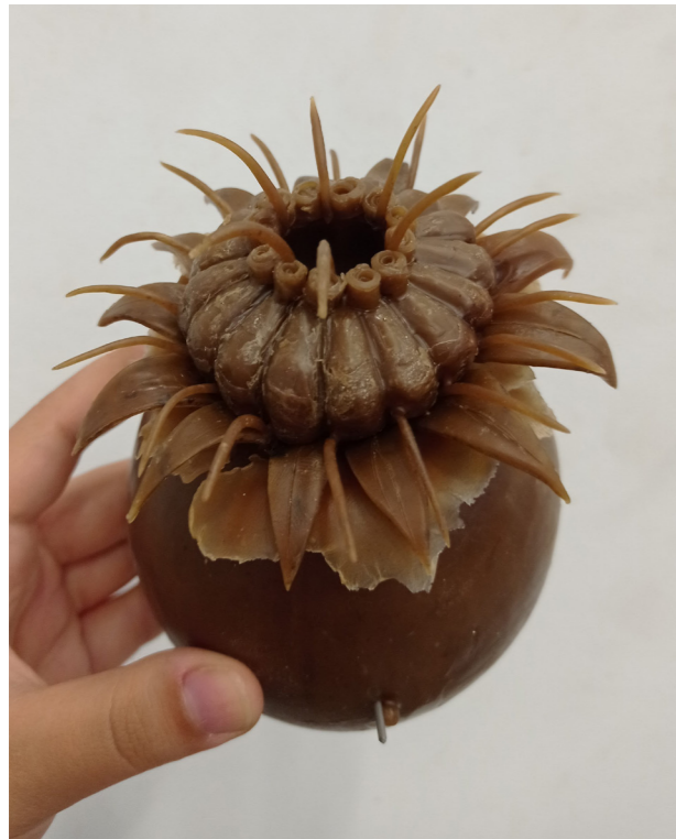
Fig. 27 Pieza 1º realizada en Microfusión.
