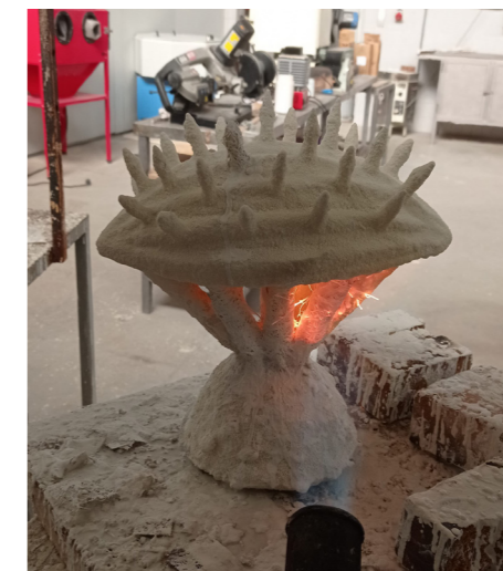
Fig. 76, 77, 78, 79, 80, 81, 82, 83, 84. Procesos completos hasta la colada directa de las dos piezas.
