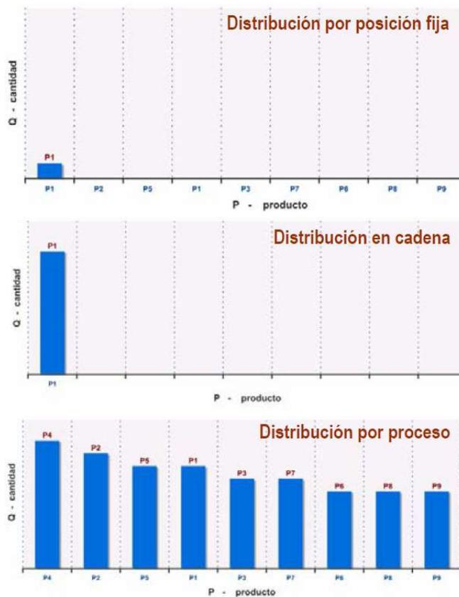
Figura 12. Gráficas para el Análisis P-Q de distintos tipos de distribución generales. Fuente: [https://unavdocs.files.wordpress.com/2010/10/diego\\_mas\\_distribucion\\_en\\_planta.pdf1](https://unavdocs.files.wordpress.com/2010/10/diego_mas_distribucion_en_planta.pdf1)
