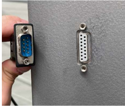
Figura 4.1: Cable para la comunicación PC - HMI.
