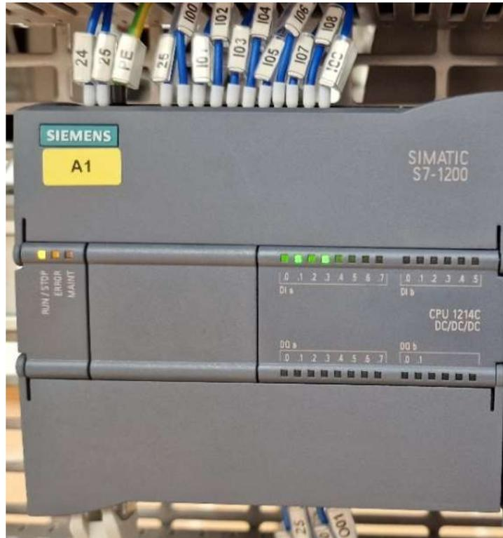
Figura 19: PLC S7-1200 utilizado para la estación FAS-209.
