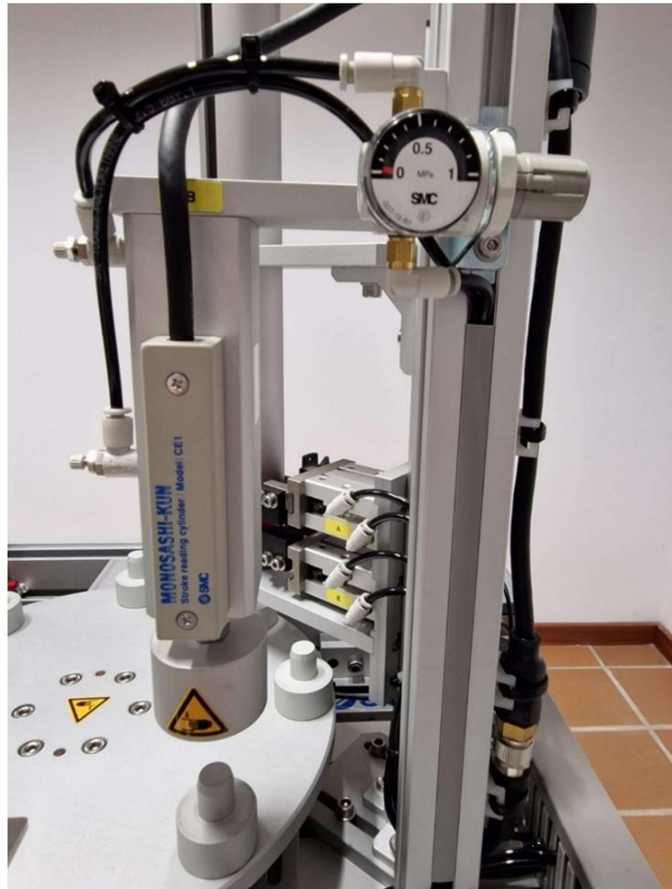
Figura 32: Medidor de alturas de la estación FAS-209.
