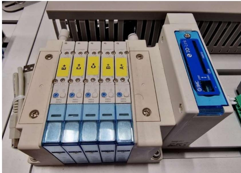
Figura 38: Bloque de electroválvulas de la estación FAS-209.
