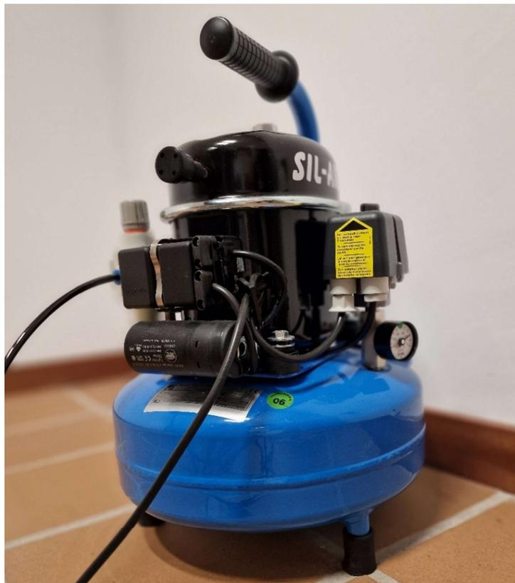
Figura 13: Compresor de aire utilizado para suministrar aire a la planta FAS-200.
