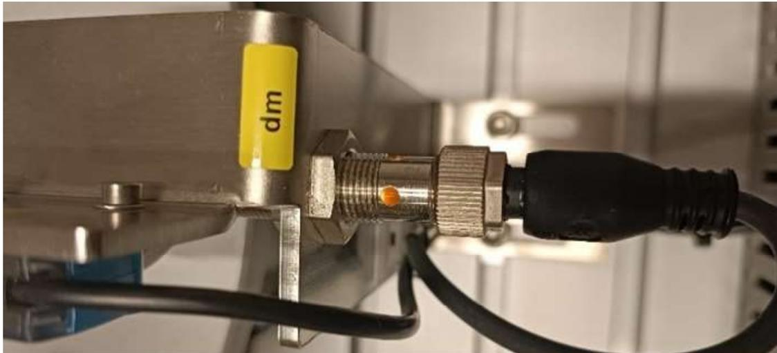
*Figura 36: Sensor inductivo de la estación FAS-209.*
