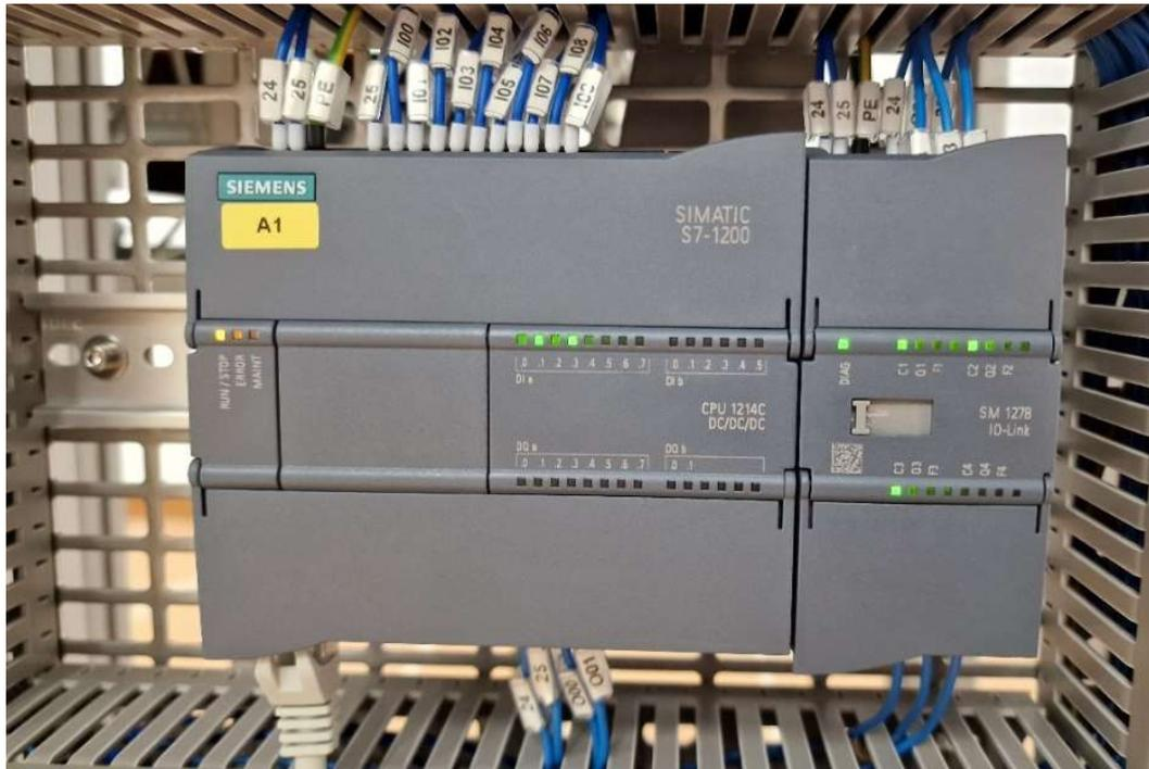
Figura 47: PLC S7-1200 utilizado para la estación FAS-209 y módulo IO-Link.
