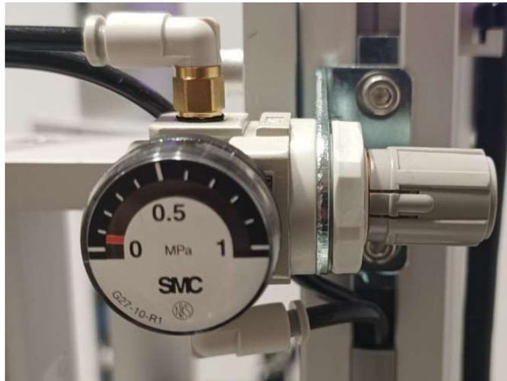
*Figura 34: Regulador de presión del medidor de alturas.*
