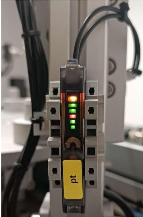
*Figura 31: Amplificador de sensor pt de la estación FAS-209.*
