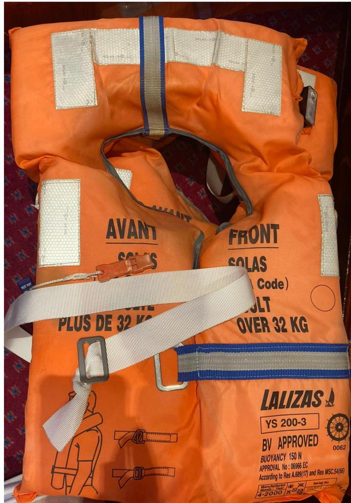
**Ilustración (9):** Chaleco salvavidas con flotabilidad de 150N homologado por el SOLAS.
