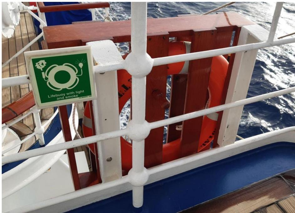
**Ilustración (12):** Señal SOLAS de aro salvavidas con luz y señal fumígena situado en el alerón del S.P.V. Royal clipper.
