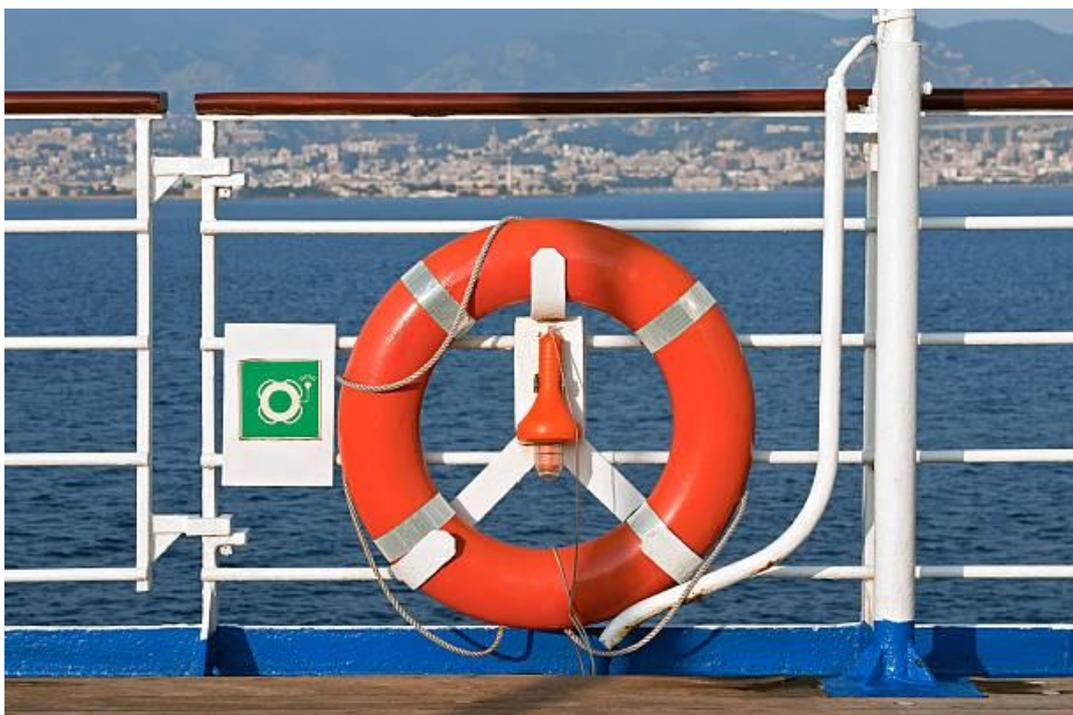
**Ilustración (4):** Aro con dispositivo luminoso.
