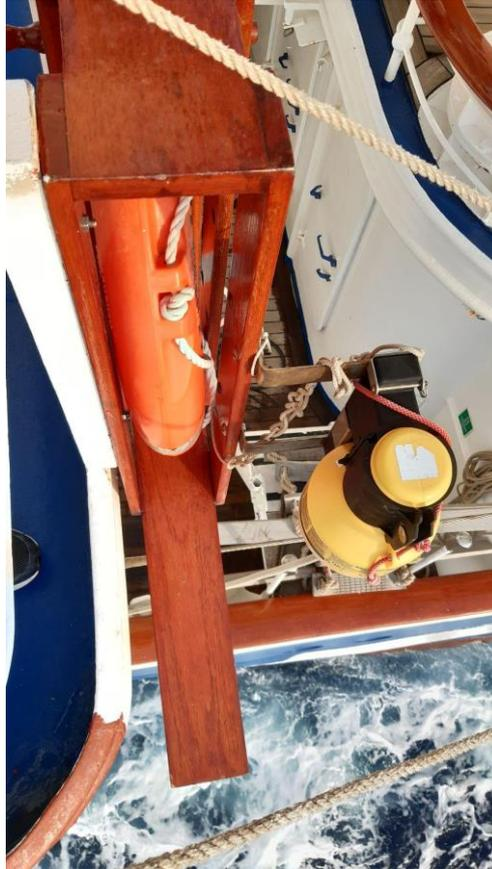
**Ilustración (5):** Aro Salvavidas unido a señal fumígena situado en el alerón del buque S.P.V. Royal clipper.
