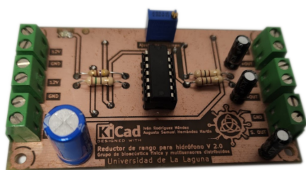
(a) Cara superior de la PCB del reductor de rango
