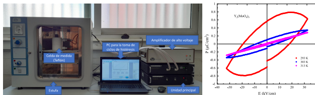
Figura 1.10: A la izquierda, setup experimental para la realización de ciclos de histéresis ferroeléctricos. A la derecha, se muestra una medida de ciclos de histéresis a varias temperaturas para una muestra de Y_2(MoO_4)_3 .
