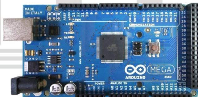
Ilustración 23: Arduino Mega 2560
