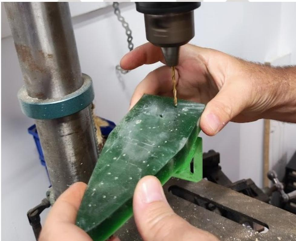
*Ilustración 43: Creación de huecos para poder anclar el motor con un destornillador.*
