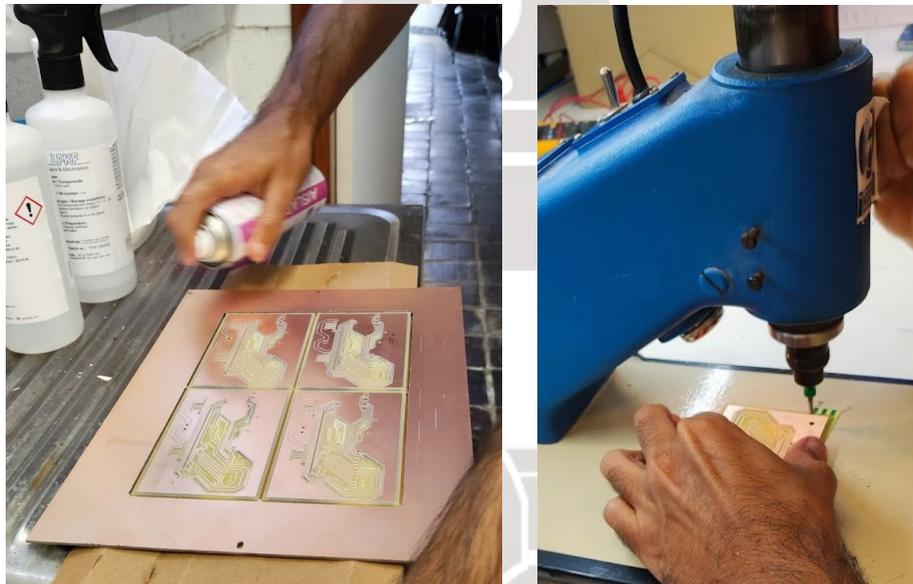
*Ilustración 34: Tratamiento posterior y generación de huecos de las placas*
