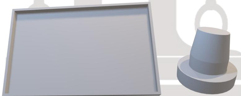
*Ilustración 15: Cajas y apoyos para los circuitos impresos*
