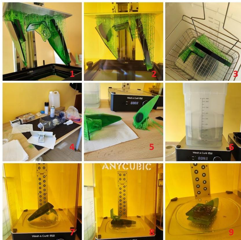
*Ilustración 19: Proceso de recogida de piezas de resinas impresas.*
