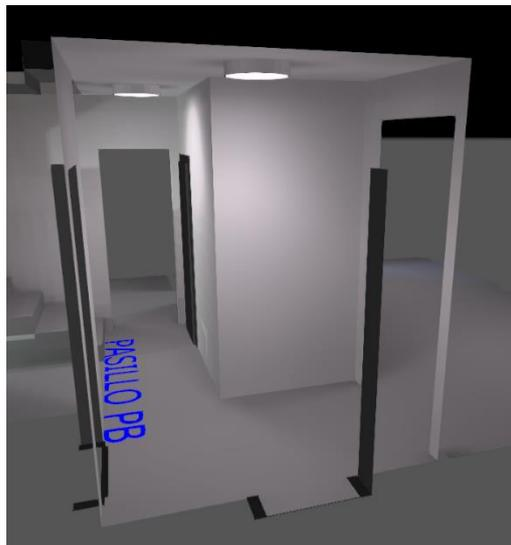
*Fig. 20: Situación luminarias del pasillo de la planta baja (fuente propia).*
