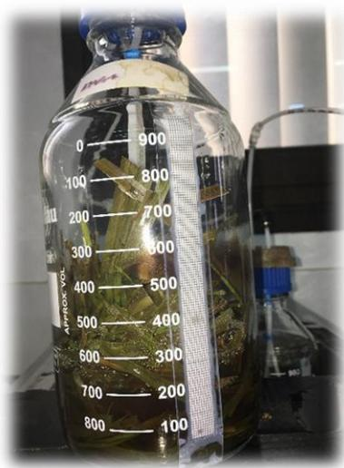
IMAGEN 6. PREPARACIÓN DE DIGESTORES
