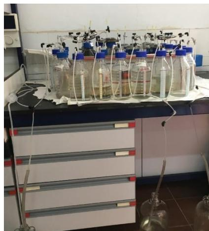
**IMAGEN 5. INSTALACIÓN EXPERIMENTAL PARA DIGESTIÓN ANAEROBIA**
