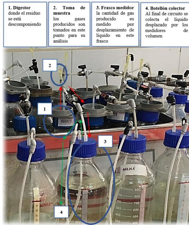
**ESQUEMA 2. DESCRIPCIÓN DE INSTALACIÓN PARA LA DIGESTIÓN ANAEROBIA**
