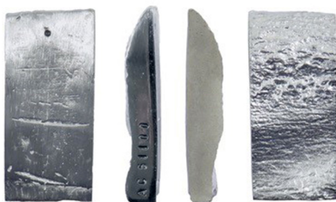
Fig. 1. Acabados superficiales de las probetas. De izquierda a derecha: satinado, brillante, mate y sin modificar.
