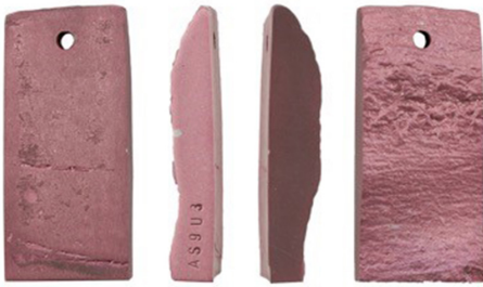
Fig. 4. Anodizado y coloreado, en rosa burdeos, de una probeta de la aleación AS9U3.
