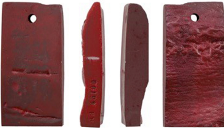
Fig. 8. Anodizado y coloreado, en rojo fuego, de una probeta de la aleación AB-46100.
