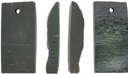
Fig. 6. Anodizado y coloreado, en verde oscuro, de una probeta de la aleación AB-44100.
