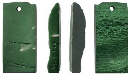
Fig. 7. Anodizado y coloreado, en verde oscuro, de una probeta de la aleación AW-51100.
