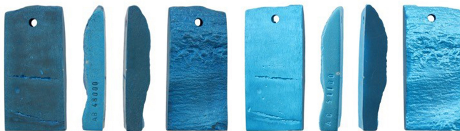
Fig. 2. Anodizado y coloreado, en azul turquesa, de una probeta de la aleación AB-48000.
