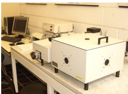
Fig. 1. Sistema experimental utilizado en las medidas de emisión y excitación con las lámparas de Xe y/o con el láser de diodo de 980 nm.
