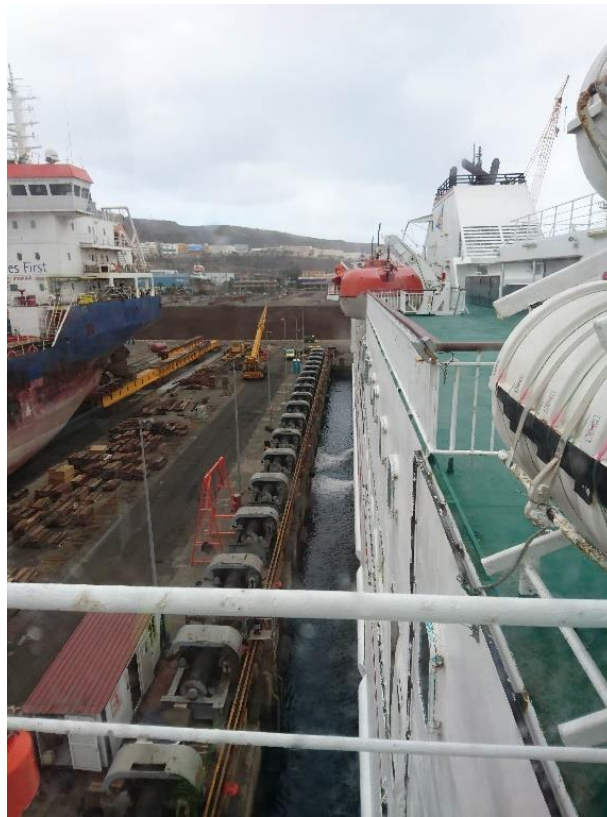
23. Vista de estribor del buque en posición. Se comienza con la comprobación por parte del equipo de buzos
