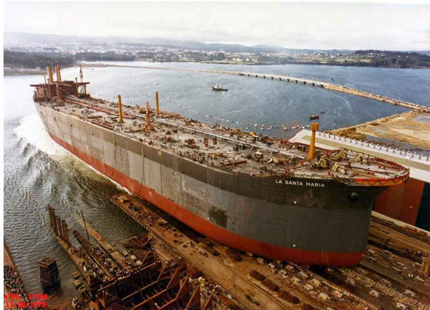
1. Botadura petrolero Santa María en el Astillero de Fene (Astano)
