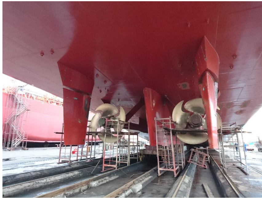
17. Montaje y calibrado de hélices y timones
