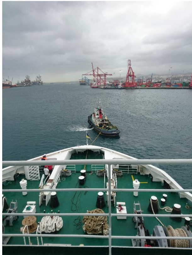
22. Vista de proa. Remolcador guiando al buque para su entrada en la Plataforma Syncrolift
