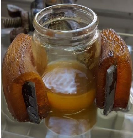
Figura 4. Recipiente con la disolución de CdS y Nitrato de Cobre en etanol listo para ser agitado por ultrasonidos
