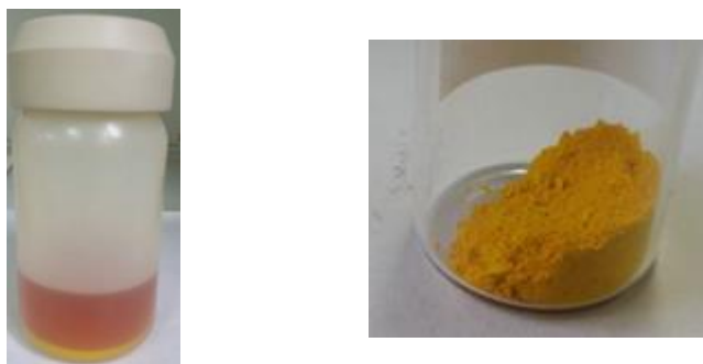
Figura 3. Disolución recién obtenida en el horno asistido por microondas, se observa el CdS de color amarillo en el fondo y la disolución sobrenadante de color más oscura (izquierda). CdS sólido después de lavar y secar (derecha)
