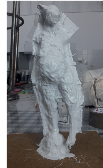
Fig. 92 - Vista frontal de la pieza con dos capas de silicona aplicadas. Se puede apreciar la realización de un borde de silicona a lo largo de toda la silueta de la pieza. Ésta sirve de sujeción al unir ambas partes del molde.
