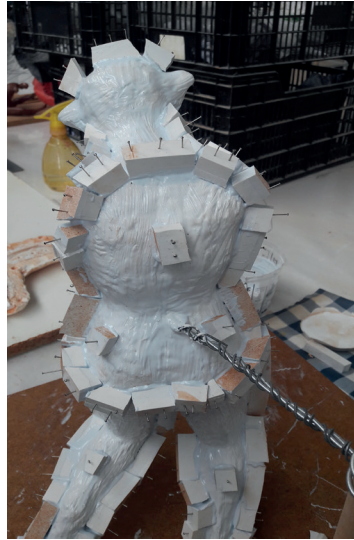
Fig. 115 - Incorporación de llaves externas con la ayuda de unos alfileres. Vista desde la parte trasera de la pieza.
