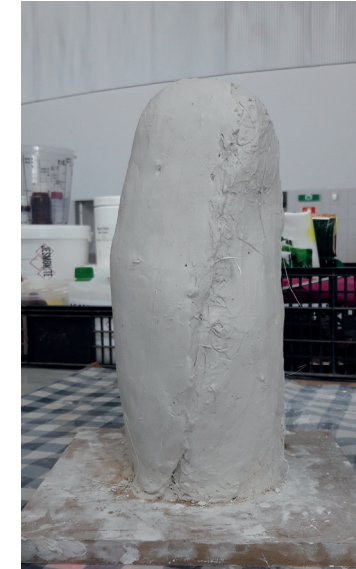
Fig. 99 - Molde terminado. Ambas partes del molde unidas durante el proceso de secado. Después, con la ayuda de un cincel y un martillo comenzaríamos a remarcar la línea divisoria para así abrir el molde.
