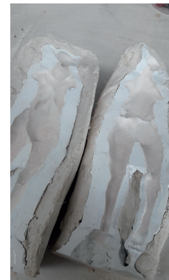
Fig. 103 - Molde abierto con la segunda capa de resina acrílica junto a la fibra de vidrio. Durante este procedimiento es esencial impregnar muy bien la fibra de vidrio con la resina acrílica, para que la unión de la primera capa con la segunda quede bien firme y se eviten posibles fisuras.
