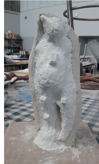
Fig. 98 - Molde de escayola o pieza madre trasera junto al molde flexible completo. Aquí se realizaron las llaves a lo largo de toda la madre forma con la ayuda de un ahuecador cortante.
