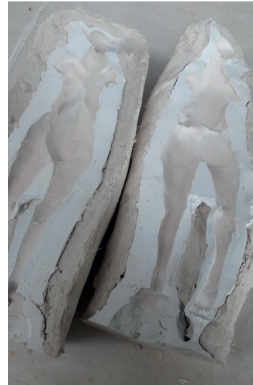
Fig. 133 - Desmoldeo, limpieza y vertido de la resina acrílica. Realizando en un primer momento una fina capa para cubrir toda la superficie de detallado.
