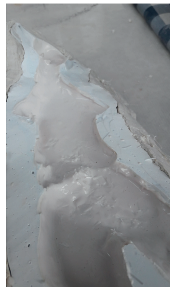
Fig. 102 - Molde abierto con la primera capa de resina acrílica vertida. Un factor importante a tener en cuenta es intentar no esparramar resina acrílica por fuera de los bordes de la silicona, dado que esto nos produciría problemas para unir ambas partes del molde posteriormente.
