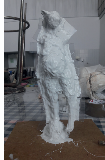
Fig. 129 - Tercera capa de silicona dada a la parte delantera de la pieza.
