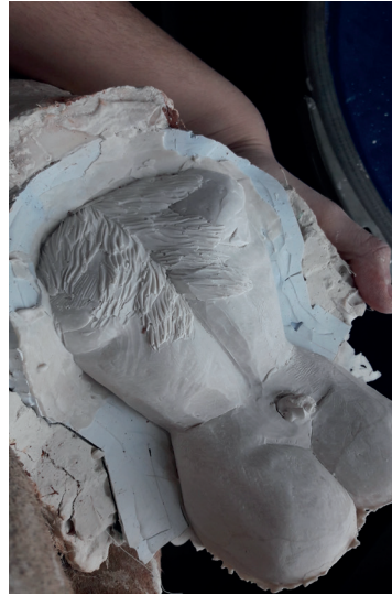
Fig. 121 - Molde relleno de resina acrílica ya solidificada y lista para el desmoldeo.
