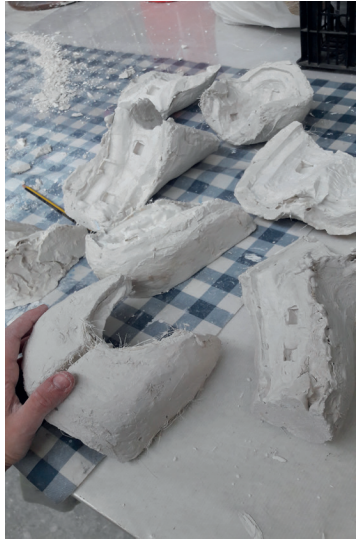
Fig. 119 - Finalización del proceso de creación del molde rígido, vista de todos los fragmentos que forman el puzzle.
