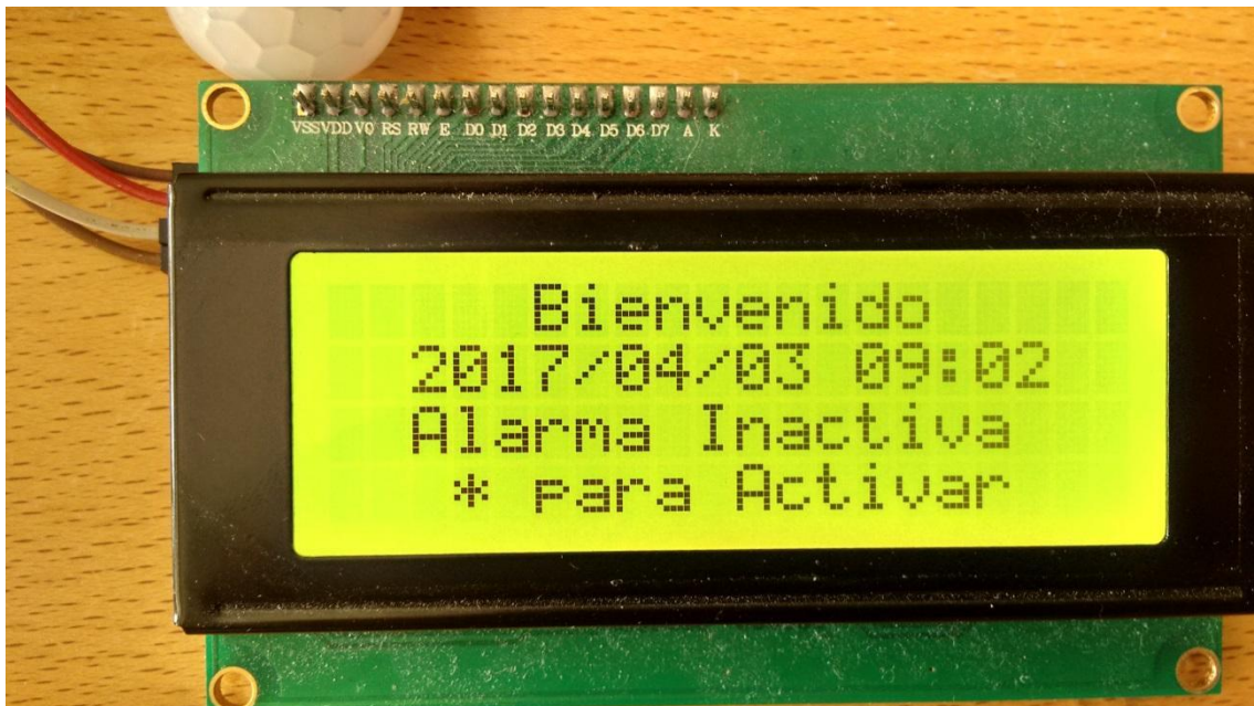
Figura VII.1 Pantalla inicial. Alarma desactivada.
