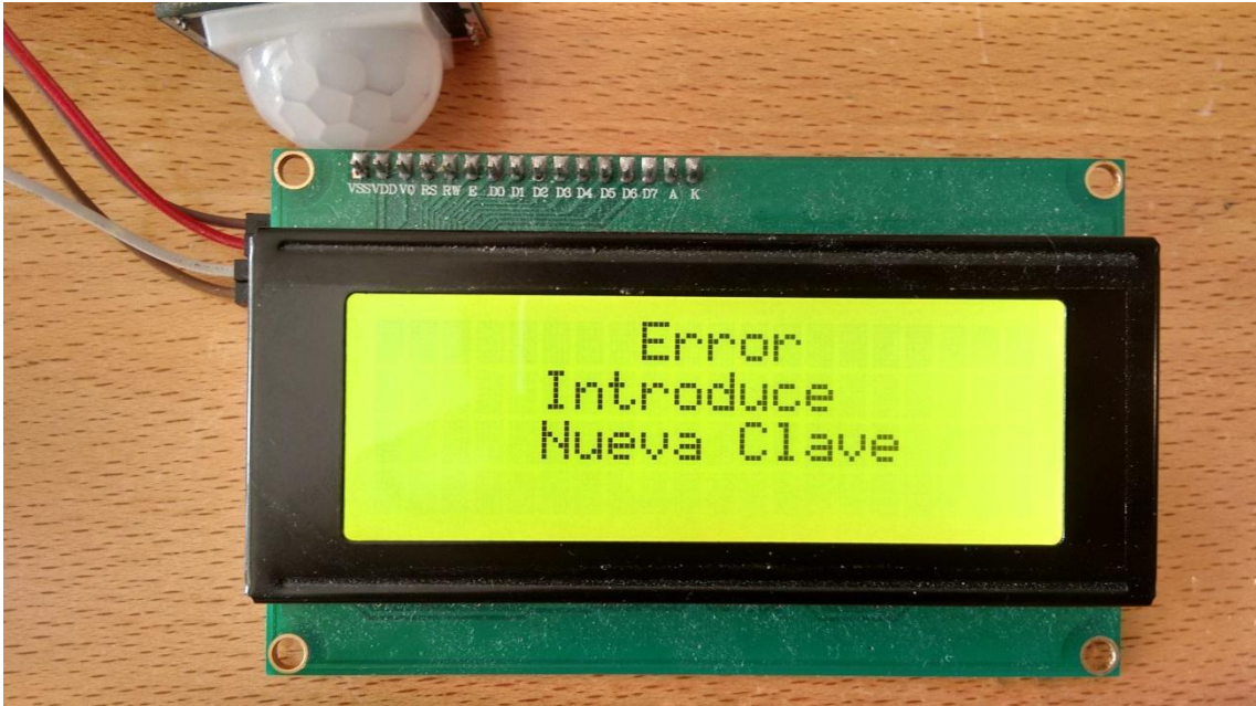
Figura VII.4. Se deberá introducir una nueva clave si la misma es incorrecta.
