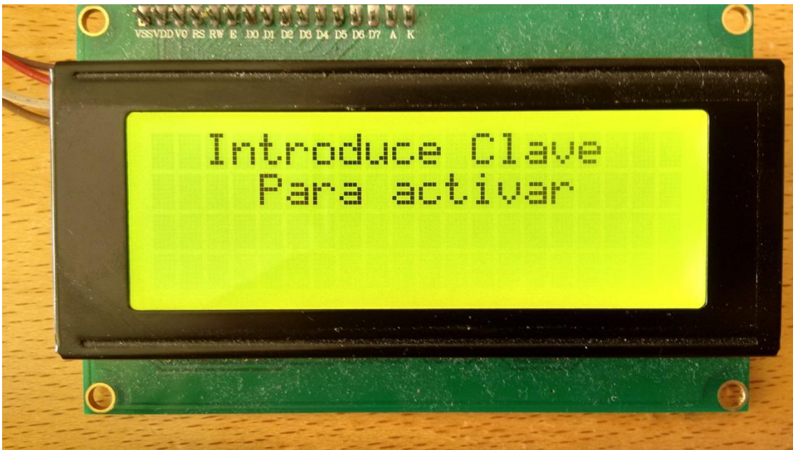
Figura VII.2. Correspondiente al mensaje mostrado en el display para activar la alarma.
