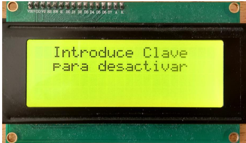
Figura IV.24. Cuarto menú. Desactivación de la alarma
