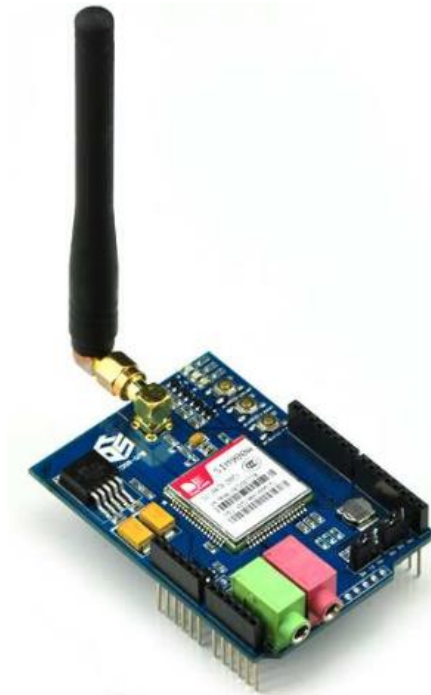
Figura III.2. Módulo GSM/GPRS SIM900 TinySine . Fuente : DataSheet del fabricante.
