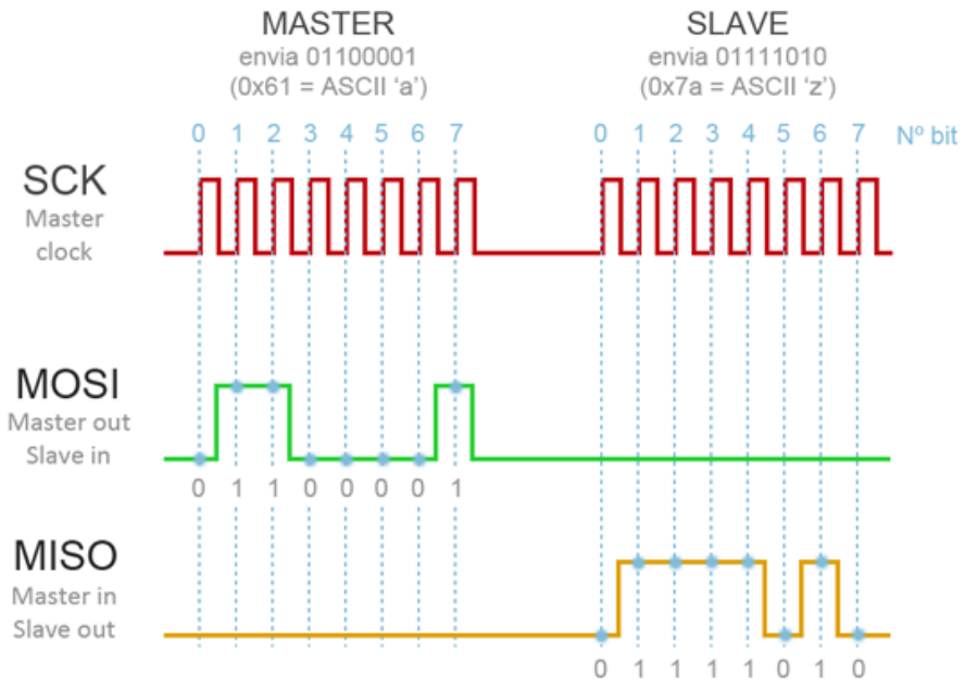
Figura II.7. Funcionamiento del protocolo SPI.
