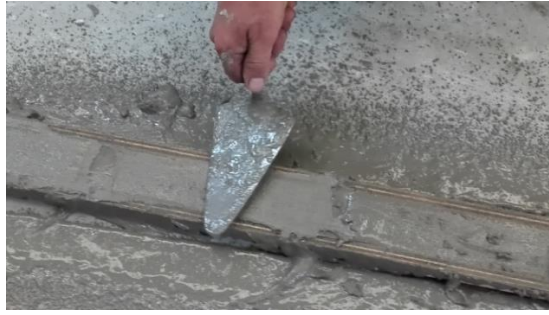
Figura 6.10. Enrasar muestras con cuchara [Fuente propia].
