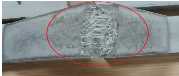
Figura 7.7. Aspecto de las fibras de vidrio en la piedra [Fuente propia].
