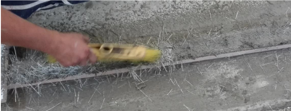
Figura 6.11. Homogeneizar muestras con cepillo [Fuente propia].
