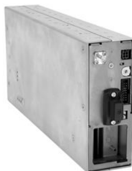
Figura 38. Recitador. Fuente: Manual TB8100. (Archivos propios CellnexTelecom. Manual TAIT8100.)
