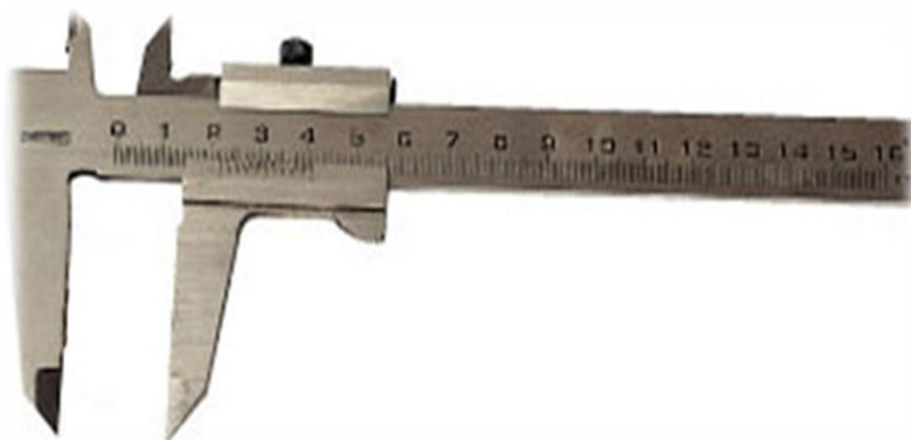
Figura 1.11 Imagen de pie de rey o calibrador.
