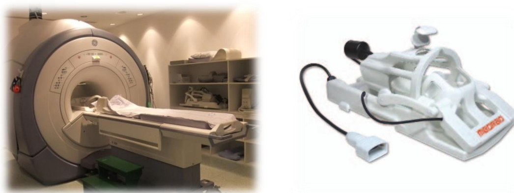
Figura 4.7. Resonancia magnética Signa HDxt de 1,5 Teslas y antena.
