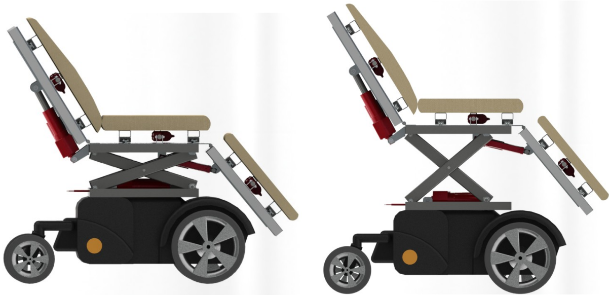
Figura 13: Asiento en reposo \theta = 20^\circ . Fuente: Figura 12: Asiento elevado \theta = 40,60^\circ . [Elaboración propia] Fuente: [Elaboración propia]
