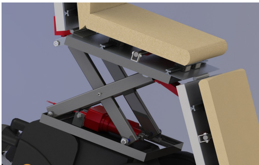
Figura 14: Colocación del actuador para mecanismo elevador. Fuente: [Elaboración propia]
