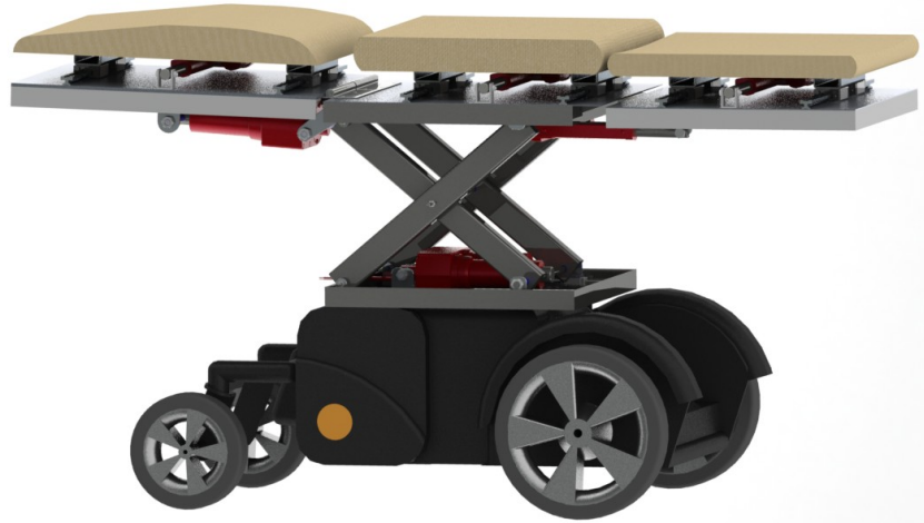
Figura 15: Asiento en posición horizontal ( \theta = 180^\circ ) y máxima altura ( \theta = 40,60^\circ ). Fuente: [Elaboración propia]
